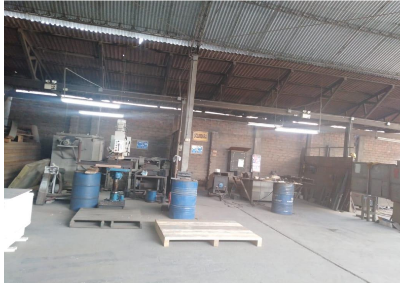
Figura 13. Distribución de planta desorganizada en el área de Soldadura
