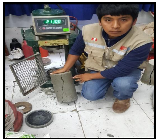
Rotura de probetas patrón y experimentales
