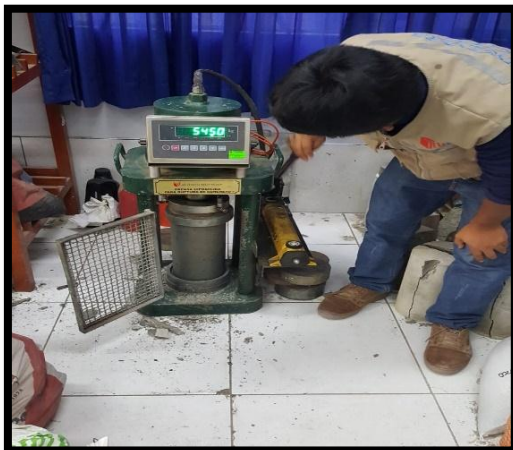
Rotura de probetas patrón y experimentales
