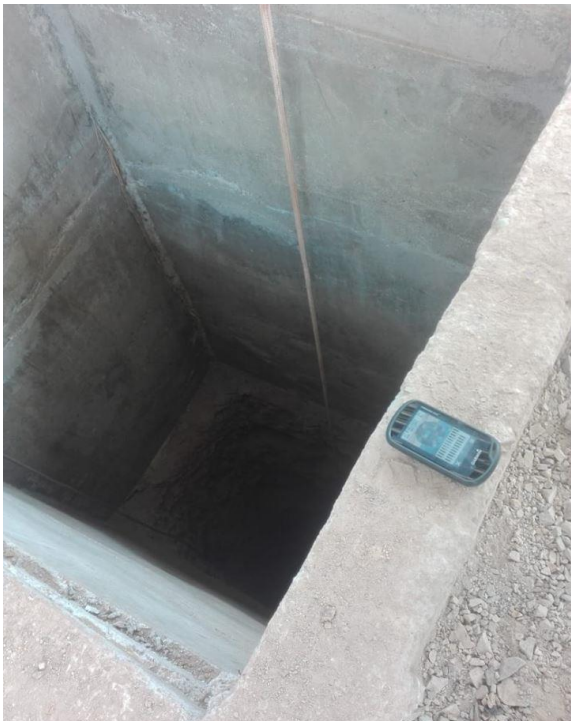
Figura N°05. Medición del BM con el GPS en el Pique 51. Fuente: propia del autor.
