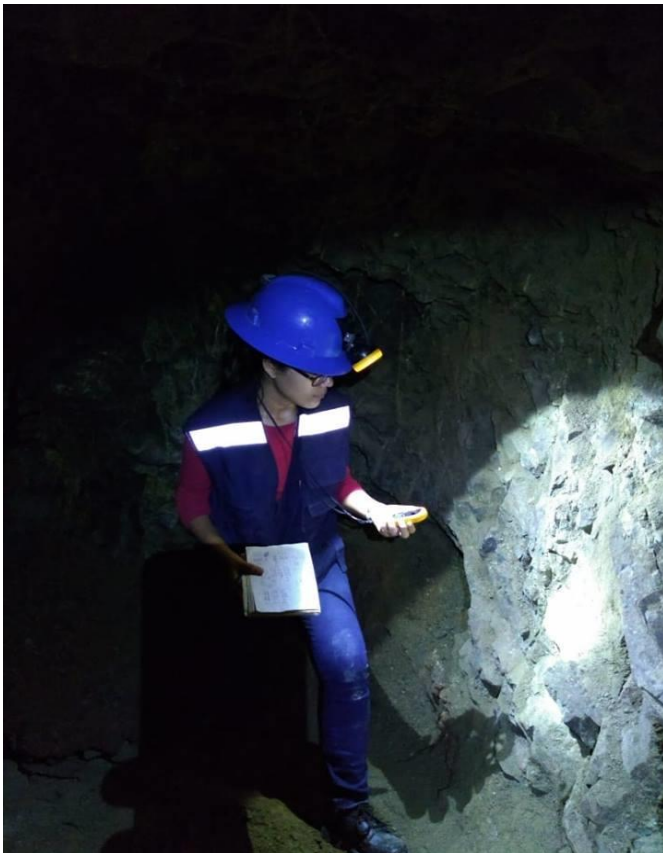
Figura N°09. Toma de datos de la velocidad de aire con el Anemómetro Digital. Fuente: propia del autor.
