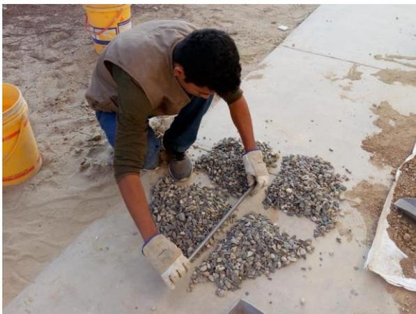
**FIGURA 41:** Procedimiento de cuarteo de muestra.
