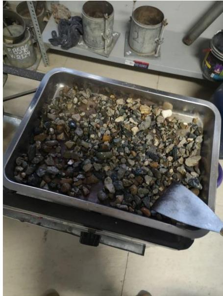
***FIGURA 44:** Secado de agregado grueso.*
