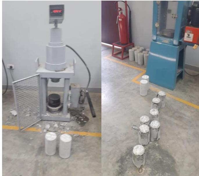
***FIGURA 51: Ensayo de compresión.***
