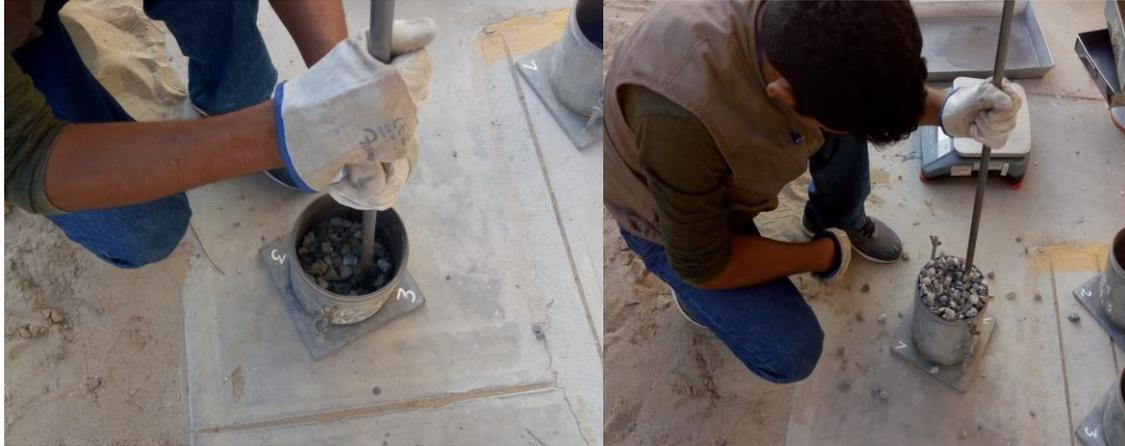
***FIGURA 48:** Varillado de material en molde.*
