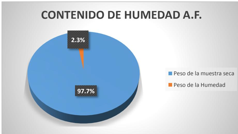
**FIGURA 3:** *Contenido de humedad MTC E-215 (agregado-fino).*
