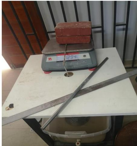
**FIGURA 47:** Determinar el peso sumergido.
