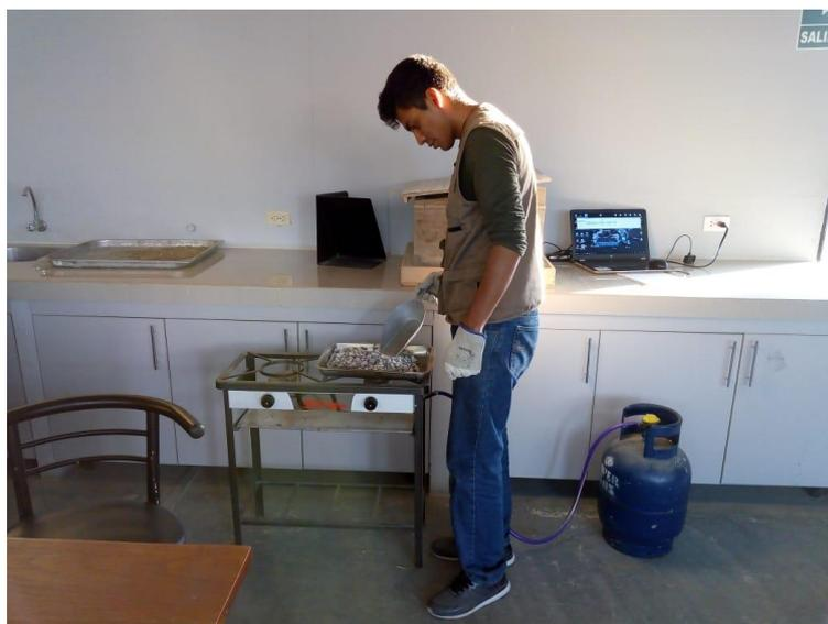
***FIGURA 45:** Secado de agregado grueso con RCD.*
