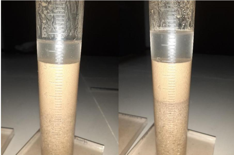
*FIGURA 50: Ensayo de equivalente de arena.*
