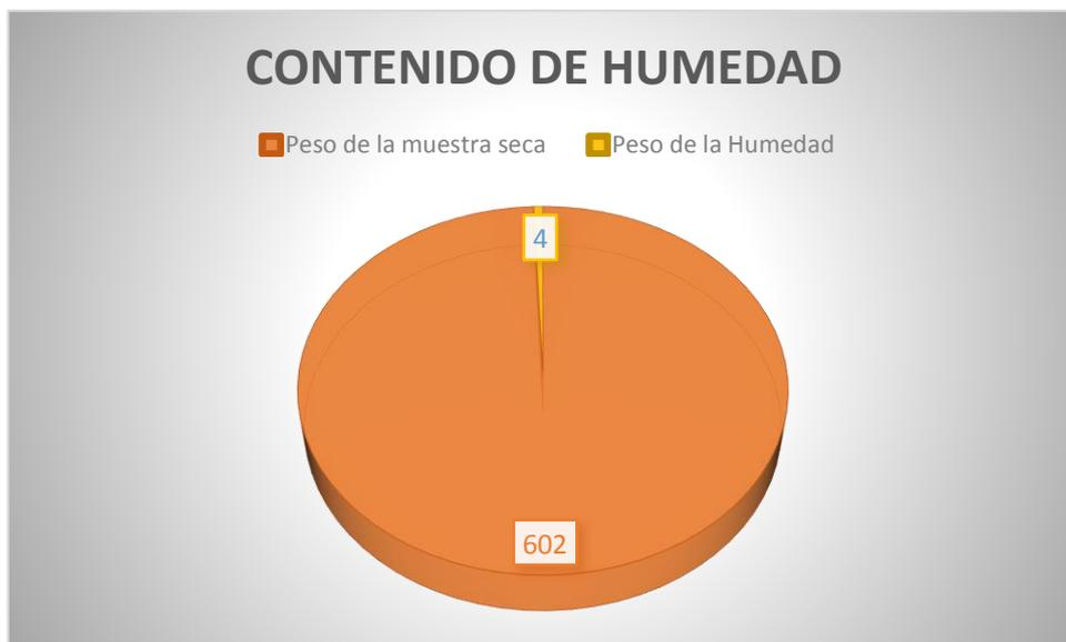
**FIGURA 21:** Contenido de humedad del agregado grueso con 25% de RCD (MTC E-215).
