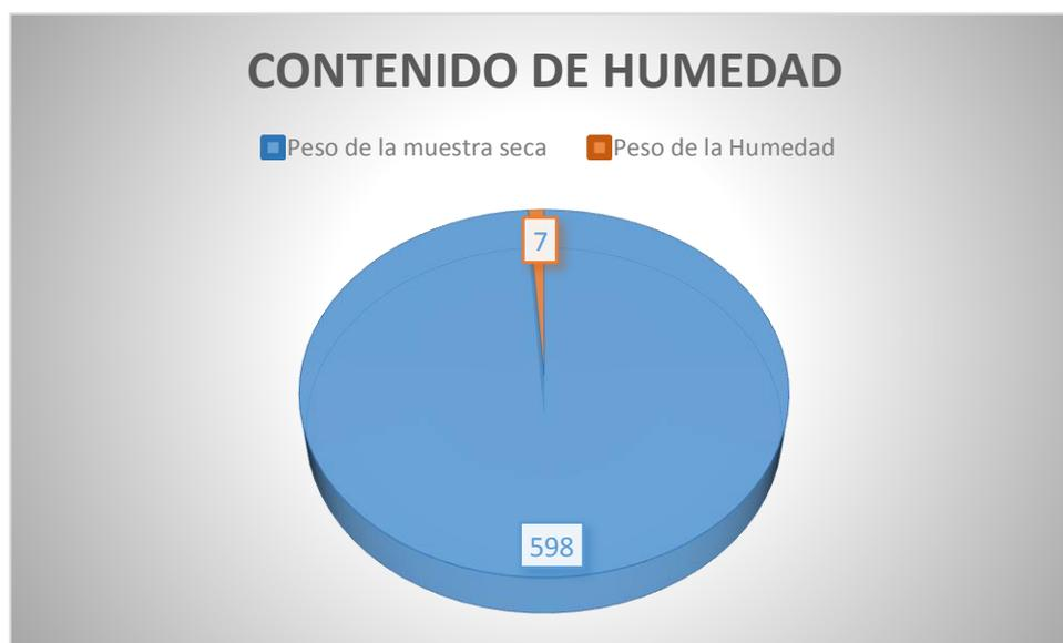
**FIGURA 27:** Contenido de humedad del agregado grueso con 50% de RCD (MTC E-215).
