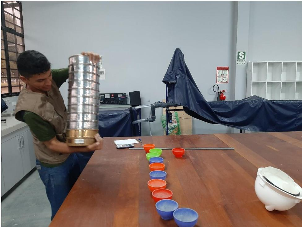
**FIGURA 42:** *Proceso de tamizado.*
