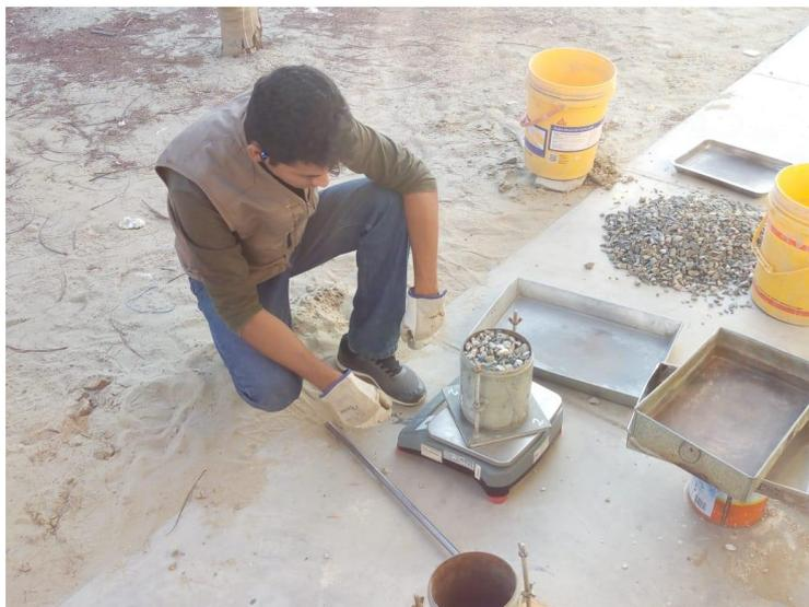
***FIGURA 49:** Pesado de muestra compactada.*
