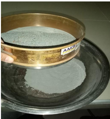
Se tamizó de la ceniza por el N°200 para que esta tenga la contextura del cemento
