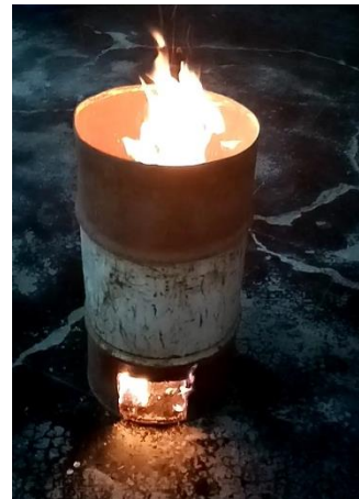
Para la quema de ceniza de cascarilla de arroz se realizaron hornos ecológicos
