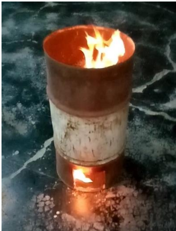
Para la quema de ceniza de cascarilla de arroz se realizaron hornos ecológicos
