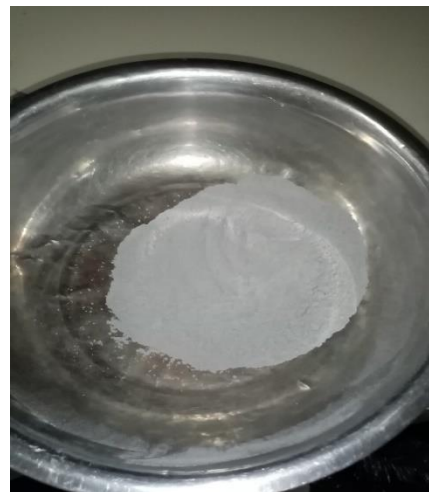
Se tamizó de la ceniza por el N°200 para que esta tenga la contextura del cemento
