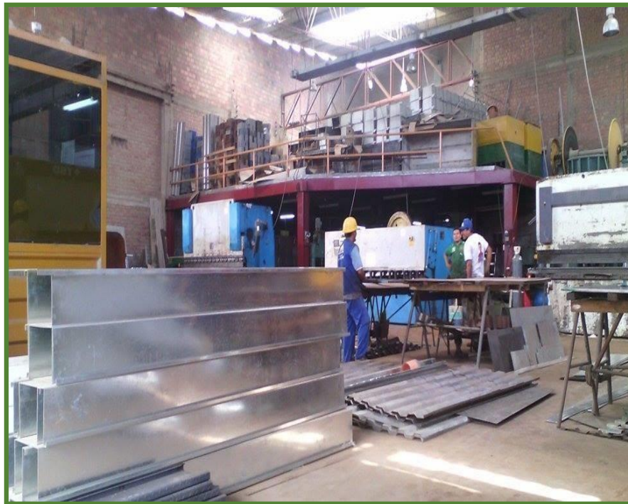
Figura 14. La materia prima se encuentra desordenada (las planchas del material a trabajar están por los suelos a vista de los trabajadores, falta concientizarlos en el tema de prevención) Fuente: Elaboración propia
