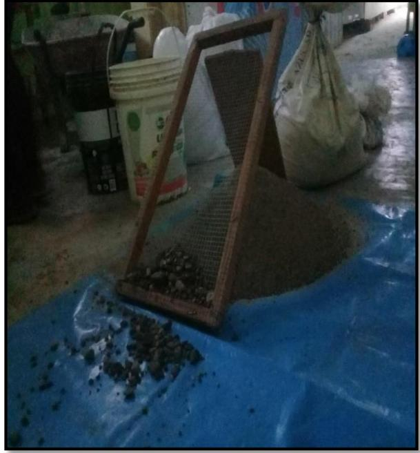
**Figura 03.16.** Agregados tamizados
