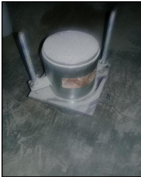
**Figura 03.11.** Peso unitario o volumétrico del material suelto.
