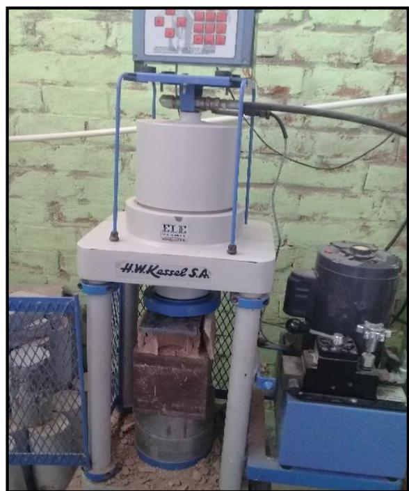
Figura 03.31. Rotura de probetas.
