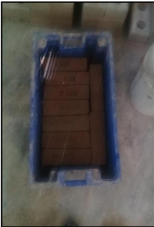
**Figura 03.29.** Bloques sumergidos por 24 horas
