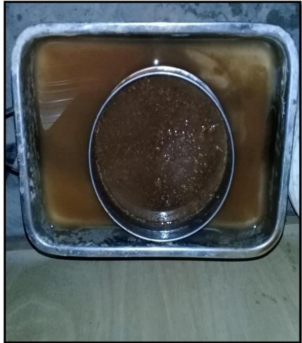
**Figura 03.02.** Lavado de muestra por malla #200 (suelo) para eliminar los finos.
