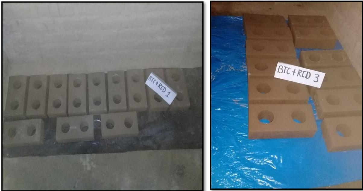
**Figura 03.27.** Bloques en cuya dosificación utilizó residuos de concreto triturados como agregado fino.
