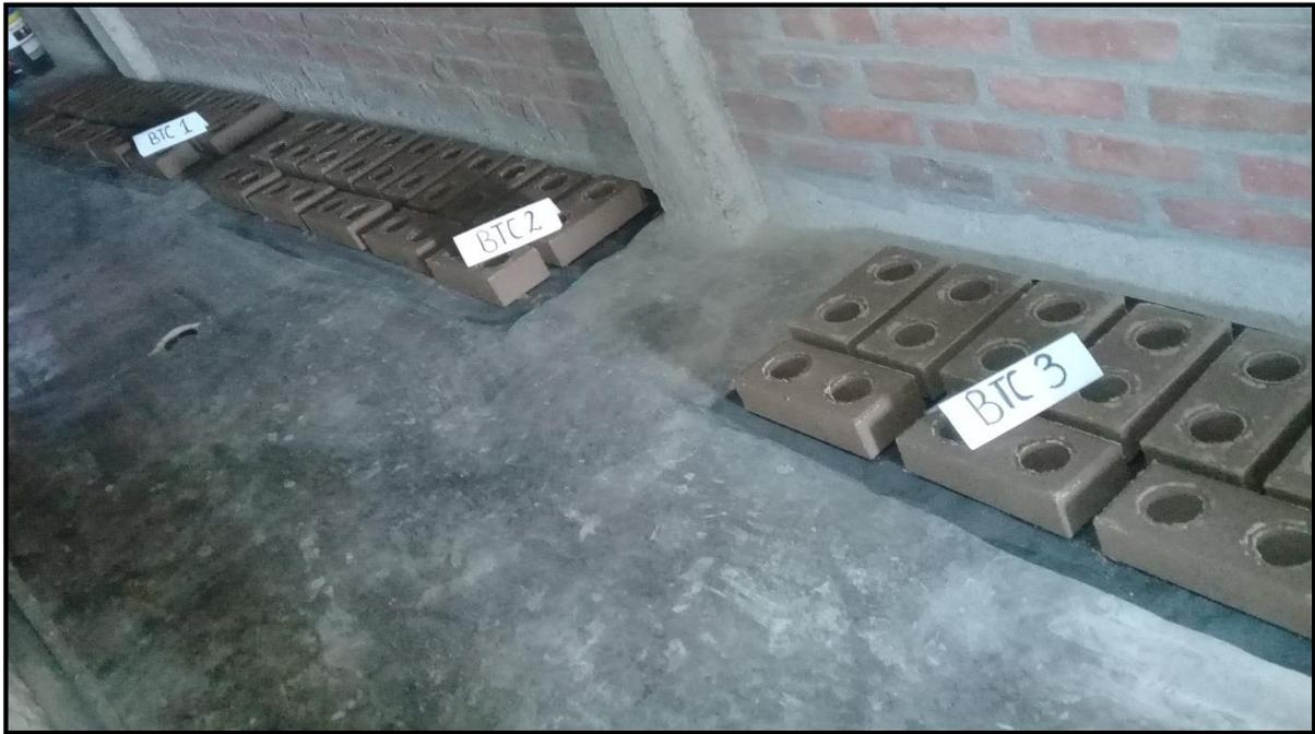
**Figura 03.26.** Bloques en cuya dosificación utilizo arena fina como agregado.
