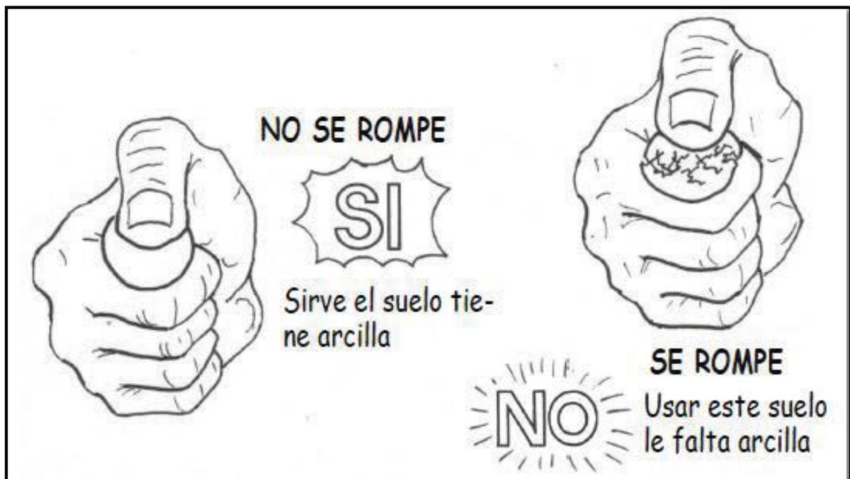
**Figura 3.** Prueba “Presencia de arcilla”. Fuente: (Instituto Boliviano del Cemento y el Hormigón, 2009) .
