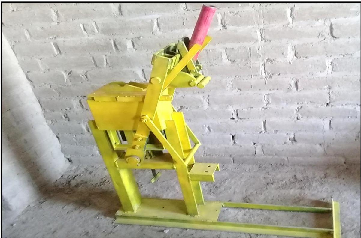
**Figura 8.** Máquina prensadora para elaborar los BTC. Fuente: (Elaboración propia).
