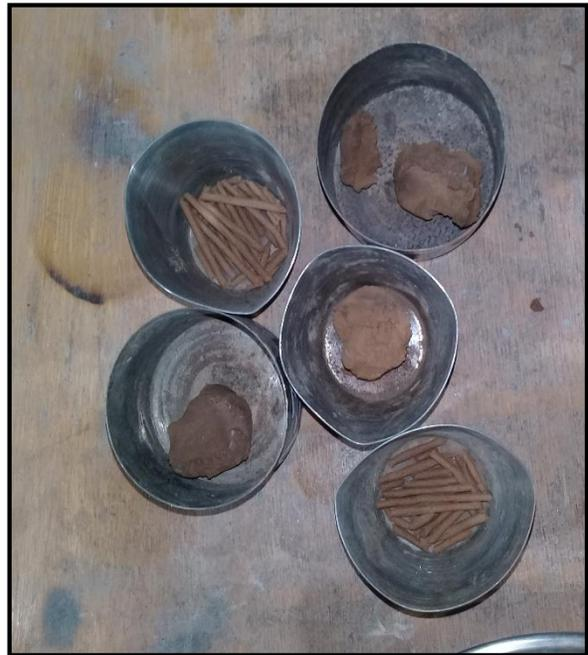
**Figura 03.08:** Muestras secas, el cual se pesa para determinar los límites.
