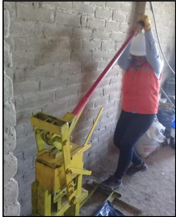
**Figura 03.23.** Comprimido de mezcla para obtener el BTC.
