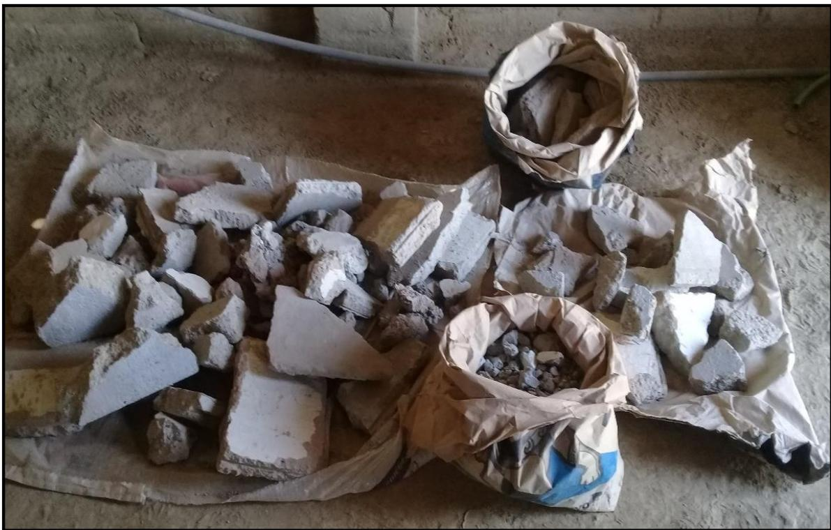
**Figura 6.** Residuos seleccionados para triturar y obtener el agregado fino.
