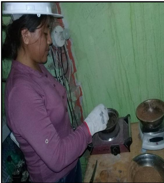
**Figura 03.03.** Secado de muestra mediante estufa para realizar el tamizado.
