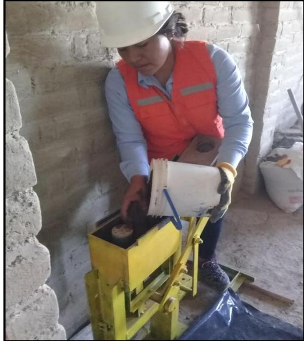
**Figura 03.21.** Llenado de mezcla en caja de máquina compresora.
