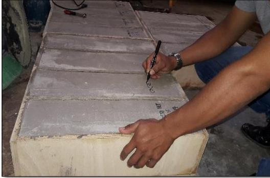
Figura 60: Identificación de probetas
