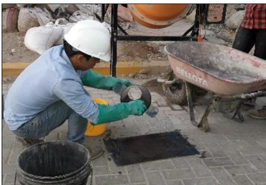
Imagen 50: Medición del Slump
