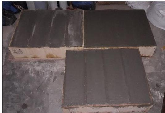
Imagen 59: Identificación de vigas prismáticas
