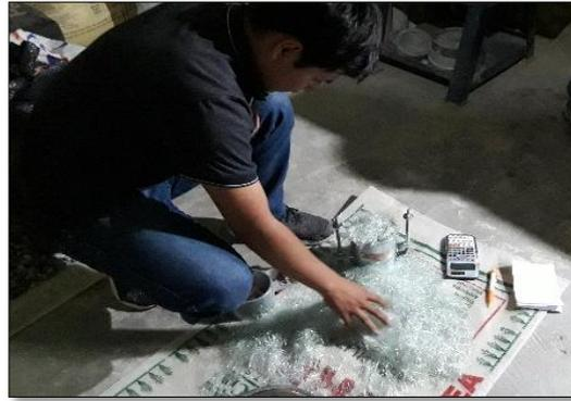
Imagen 30: Granulometría de los agregados
