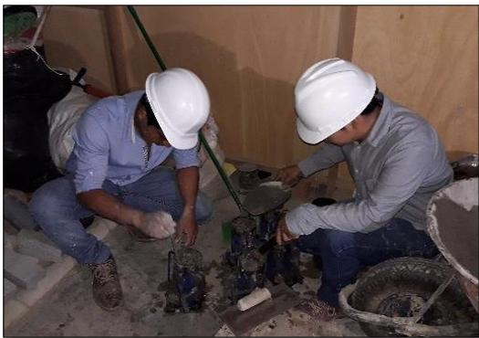
Imagen 56: Varillado p/capas-Vigas prismáticas
