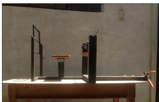
Imagen 15: Colocación del eje central p/botellas
