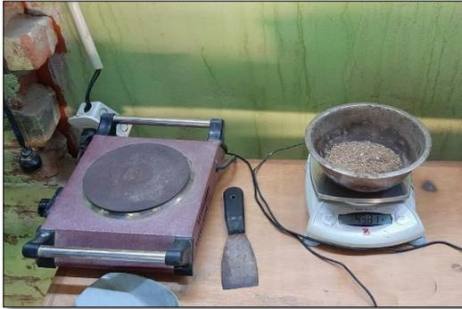
Imagen 31: Peso específico de la arena
