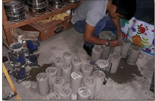
Imagen 61: Curado del probetas y vigas prismáticas en piscina
