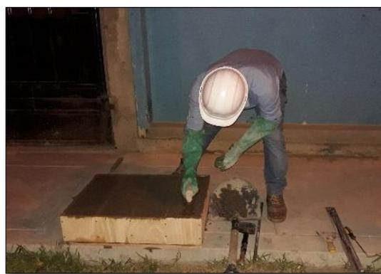
Imagen 54: Moldeo p/capas - Vigas prismáticas
