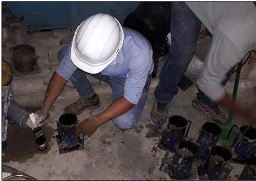
Imagen 55: Moldeo p/capas - Vigas prismáticas
