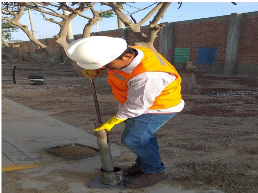
*Fotografía 116: Ejecución del ensayo a base de los 25 golpes de las 5 capas de la muestra.*
