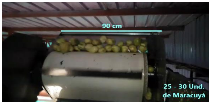
Figura 09. Dimensionamiento y abastecimiento de la faja transportadora
