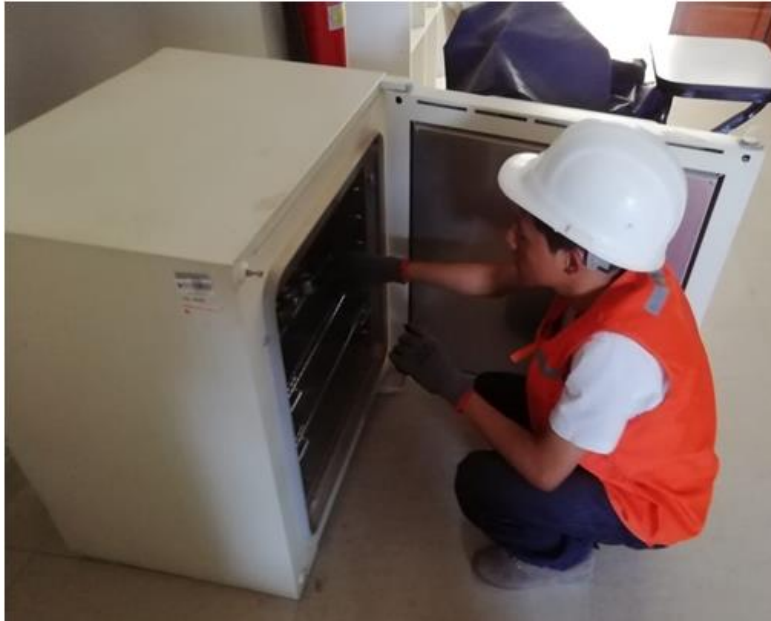
Figura 26: Puesta de las muestras en el horno de la C – 1
