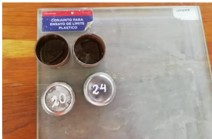
Figura 35: Muestras pesadas y listas para secado de 24 horas
