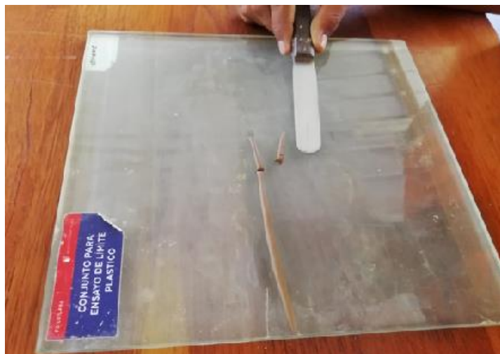
Figura 25: Realizamos un rollo de 3mm de espesor y verificamos donde se fractura
