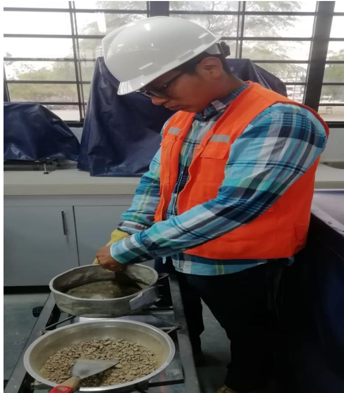
Figura 13: Secado de muestra
