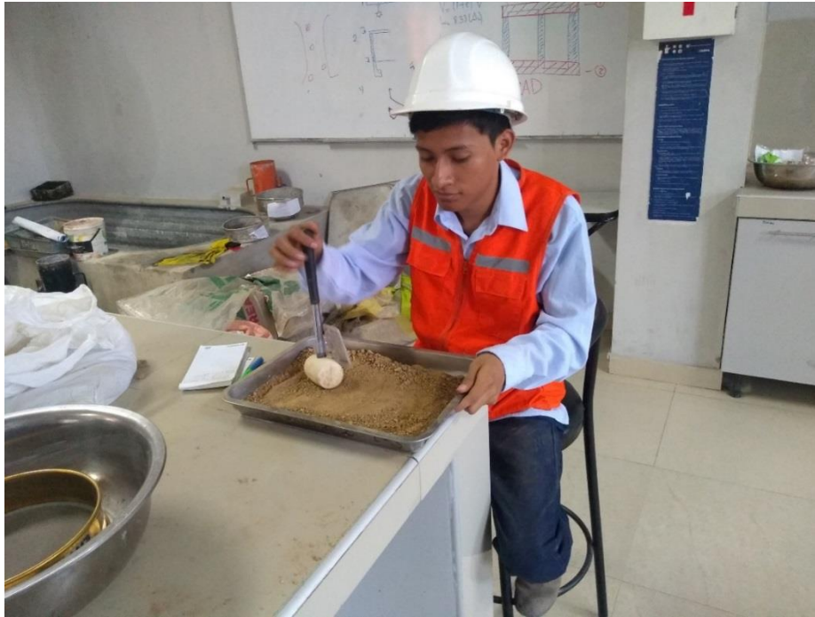
Figura 3: Triturando la muestra C-1
