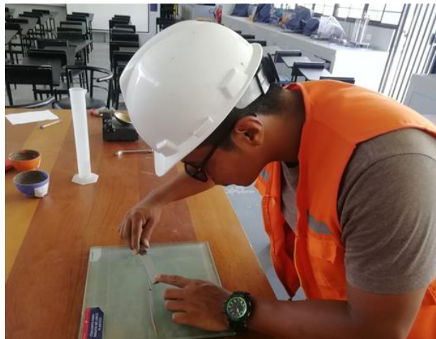
Figura 34: Obtenemos 2 partes del rollo en donde esta fracturado y pesamos la muestra
