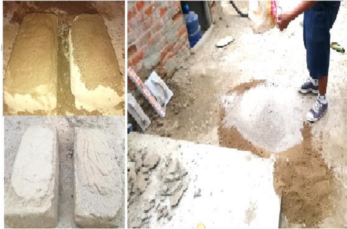
Figura 43: Mezcla de tierra con arena gruesa (1:2)
