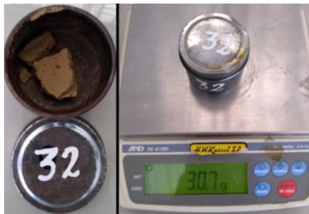
Figura 38: Peso de muestra seca
