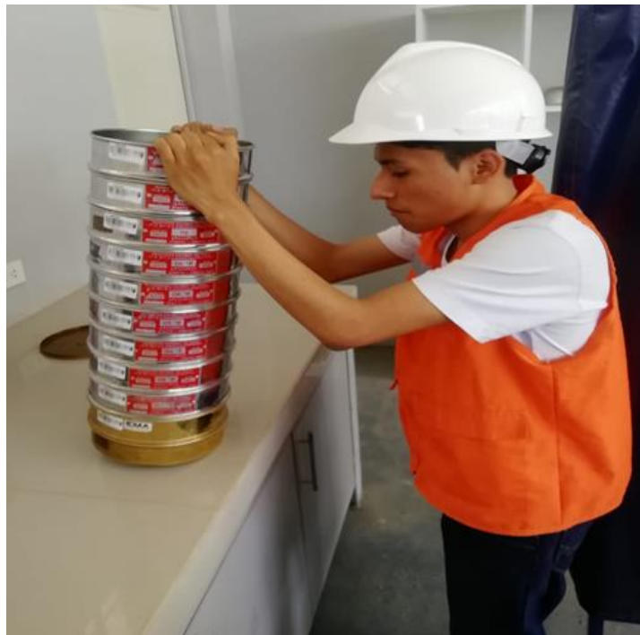
Figura 14: Tamizado de la muestra desde la malla N°4 hasta la N°200
