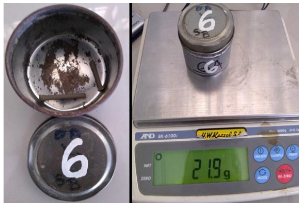
Figura 28: Peso de muestra seca
