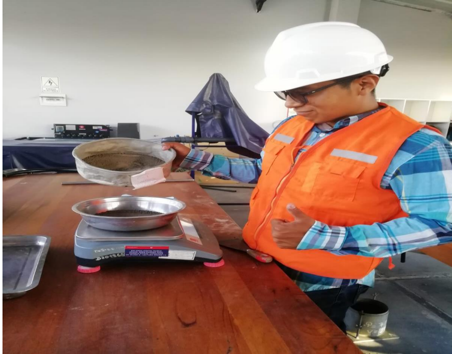
Figura 11: Pesamos 500 gr de la muestra
