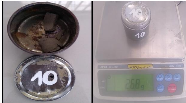
Figura 21: Peso de muestra seca
