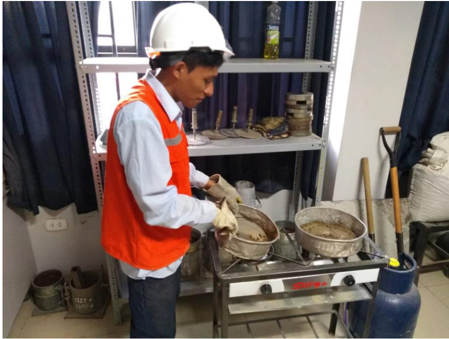
Figura 5: Secado de la muestra.
