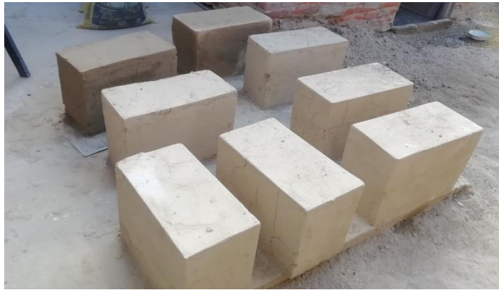
Figura 56: Producto final de 8 pilas de adobe, protegidas del sol y viento
