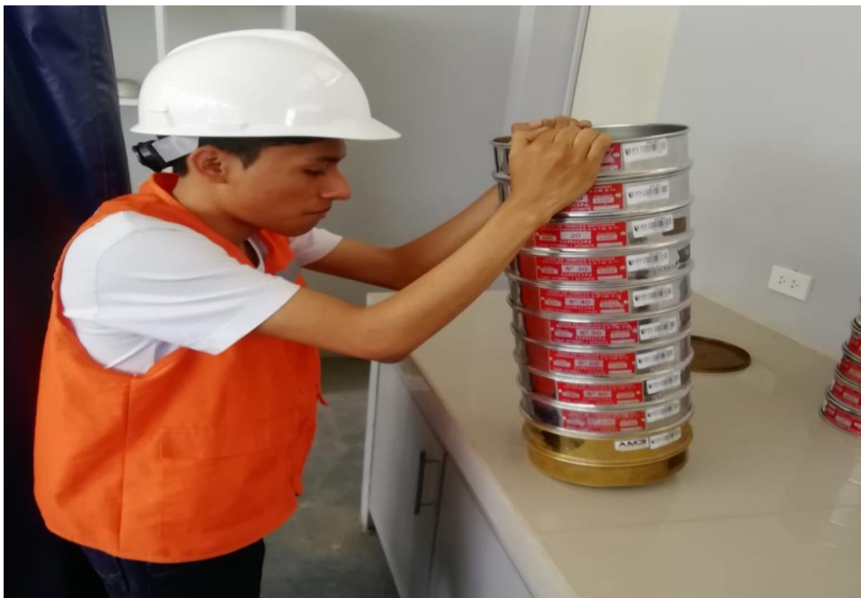
Figura 6: Tamizado de la muestra desde la malla N°4 hasta la N°200
