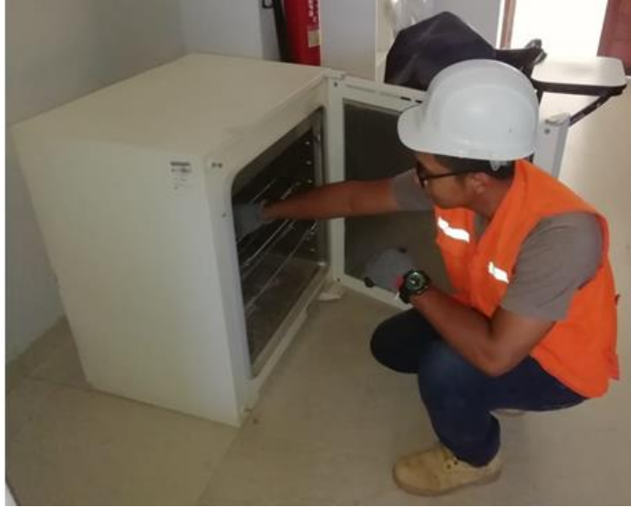
Figura 36: Puesta de las muestras en el horno de la C-2
