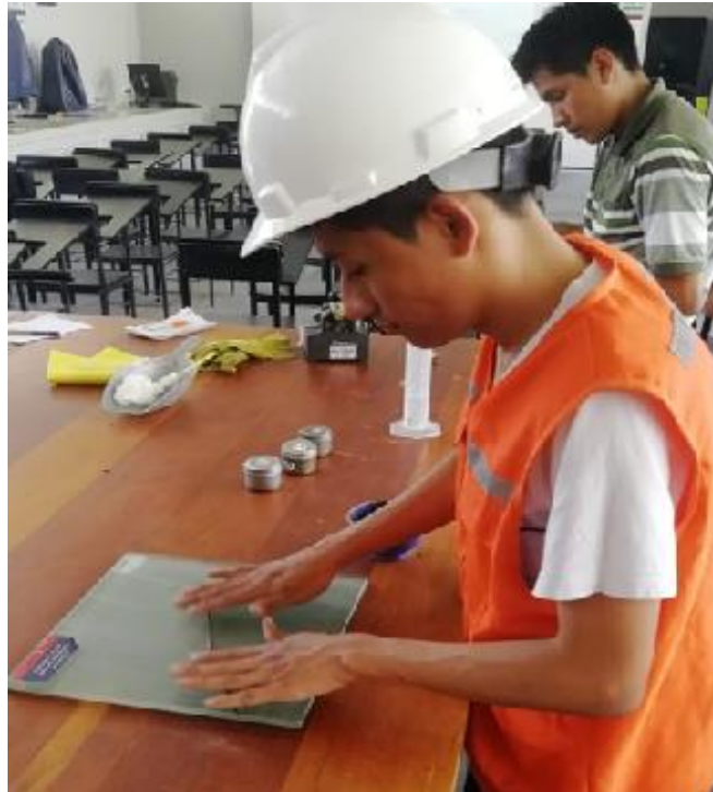
Figura 24: Realizamos un rollo de 3 mm de espesor
