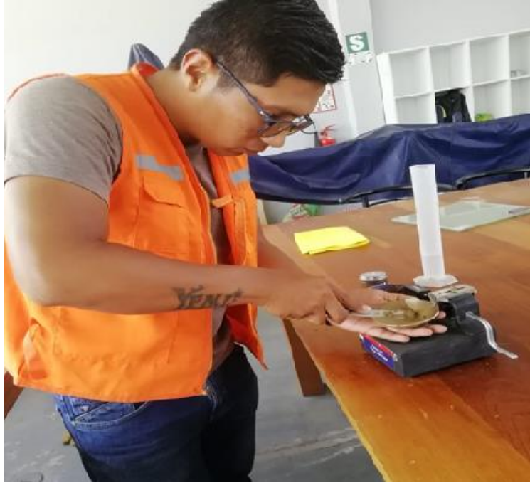
Figura 31: Colocación de muestra en la copa.
