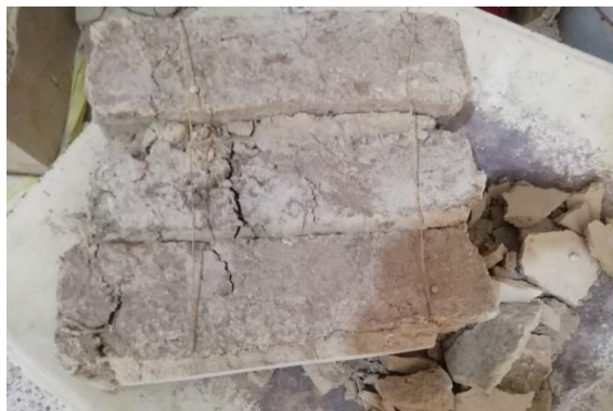
Figura 62: Notamos la diferencia del desprendimiento del mortero sin reforzar, además de las grietas producidas por la presión de la máquina
