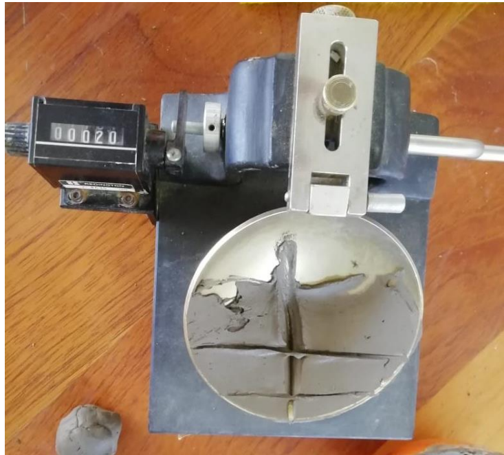
Figura 32: Obtención de la muestra con cerrado a los 20 golpes
