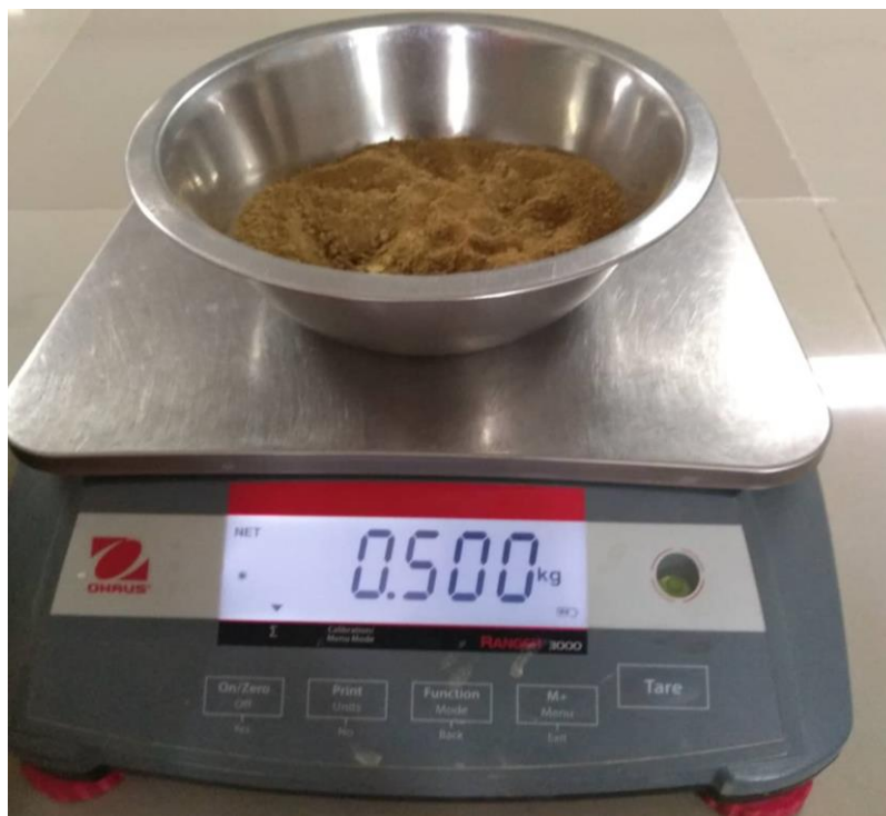
Figura 4: Taramos el recipiente y pesamos 500 gr de la muestra triturada y procedemos a lavar
