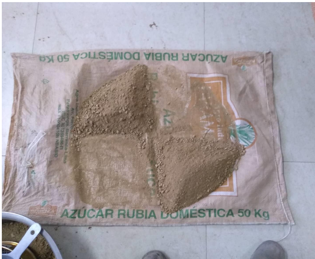
Figura 2: Cuarteamos la muestra y escogemos los lados diagonales
