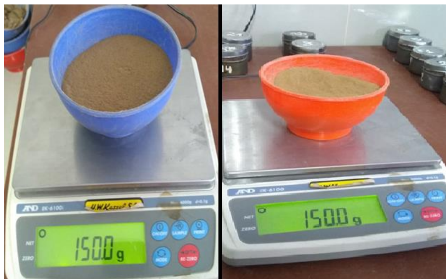
Figura 16: Pesamos 150 gr del material pasante de la malla N° 10 para los ensayos líquido y plástico
