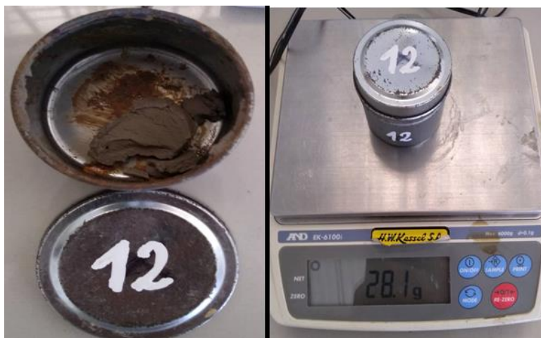
Figura 23: Peso de muestra seca
