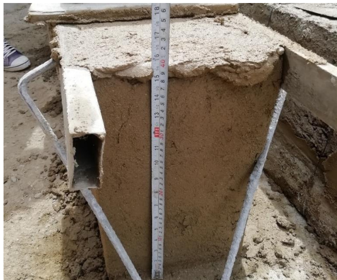
Figura 51: Medimos la altura de 40cm, dato requerido para el ensayo de compresión
