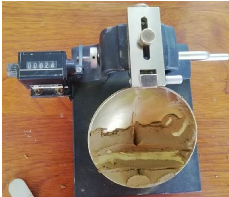
Figura 20: Cierre de muestra en 24 golpes y selección para secado
