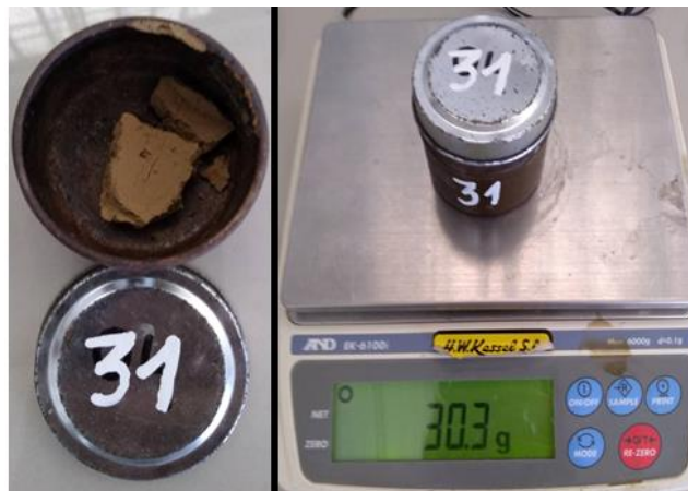
Figura 37: Peso de muestra seca
