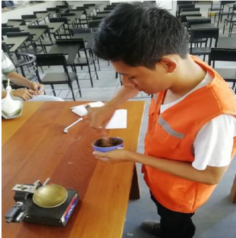
Figura 17: Mezclado de la muestra para límite líquido
