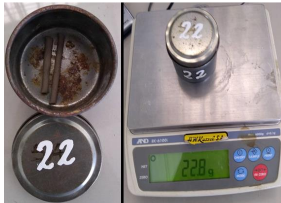
Figura 27: Peso de muestra seca
