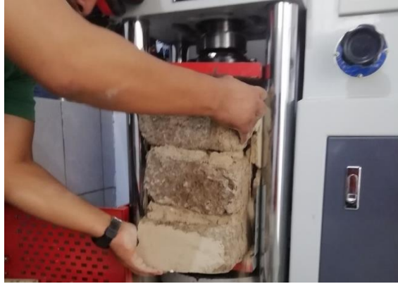
Figura 61: Ensayo de compresión de la pila de adobe sin reforzar
