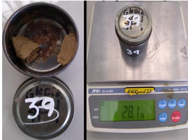
Figura 39: Peso de muestra seca
