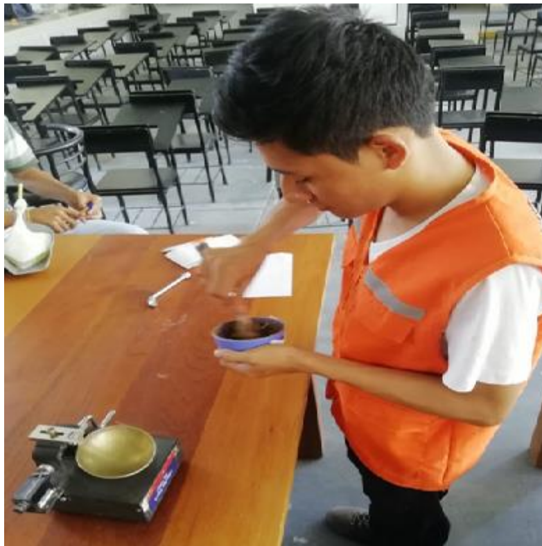
Figura 30: Mezclado de la muestra para LL
