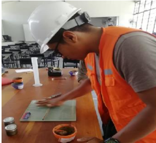
Figura 33: Realizamos un rollo de 3 mm de espesor y verificamos donde esta fracturado
