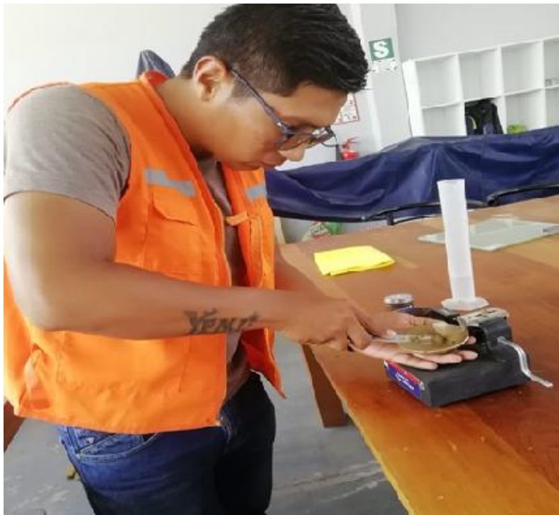
Figura 18: Colocación de muestra en la copa
