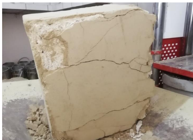
Figura 60: Resultado final, el mortero sigue adherido a la pila de adobe reforzado
