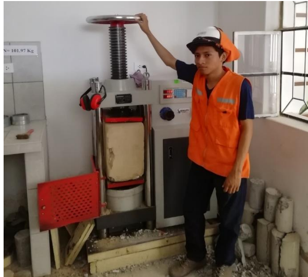
Figura 58: Vista de prensa hidráulica con la pila de adobe
