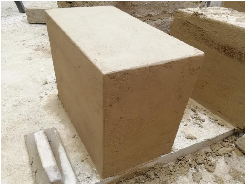
Figura 53: Producto final de las pilas de adobe
