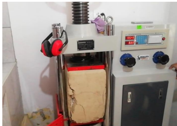
Figura 59: Ensayo de compresión a la pila de adobe reforzada con geomalla
