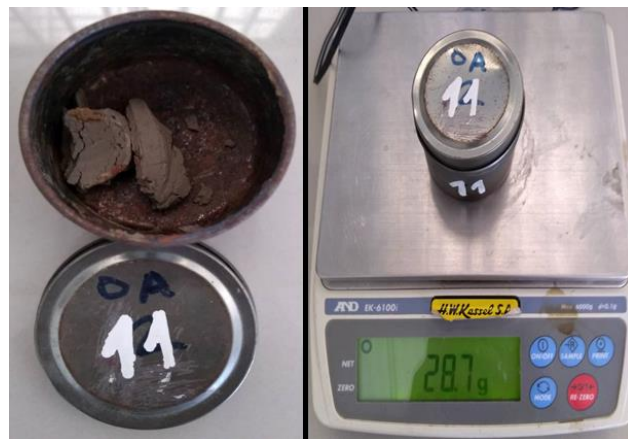
Figura 22: Peso de muestra seca
