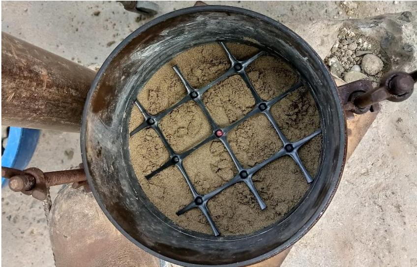
Fotografía N° 7: Moldes de CBR sumergidos en tanque
