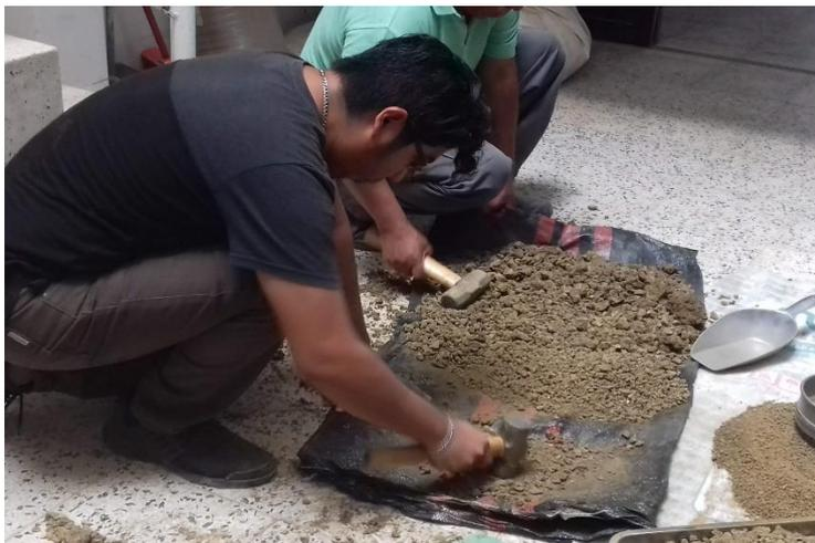
Fotografía N° 3: Mezcla de la muestra con proporciones de agua
