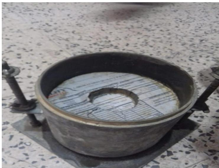
Fotografía N° 10: Huella del pistón de carga espécimen con geomalla biaxial
