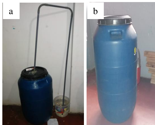
Figura 3: Sistema de biodigestión: a) Biodigestor y b) Proceso de biodigestión
