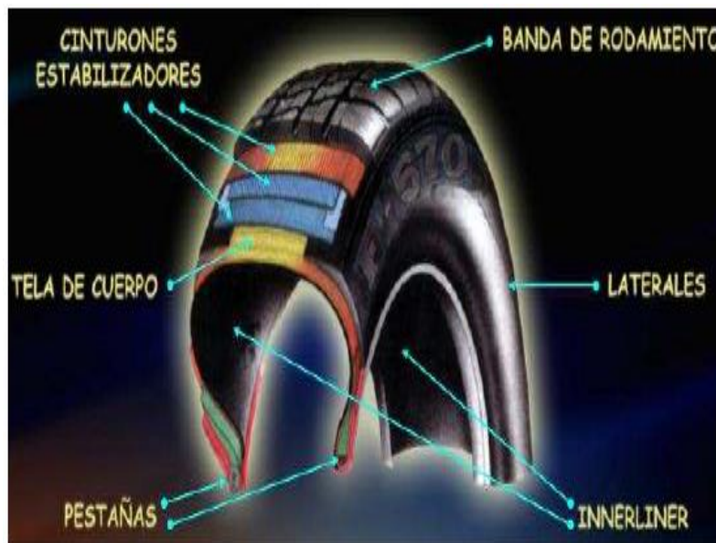
Figura 3 Componentes de un neumático
