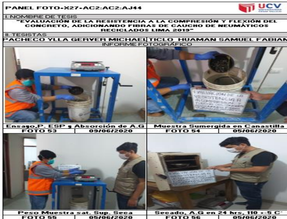
Panel Fotográfico 16: Ensayo de Peso Específico y Absorción de Agregado Fino
