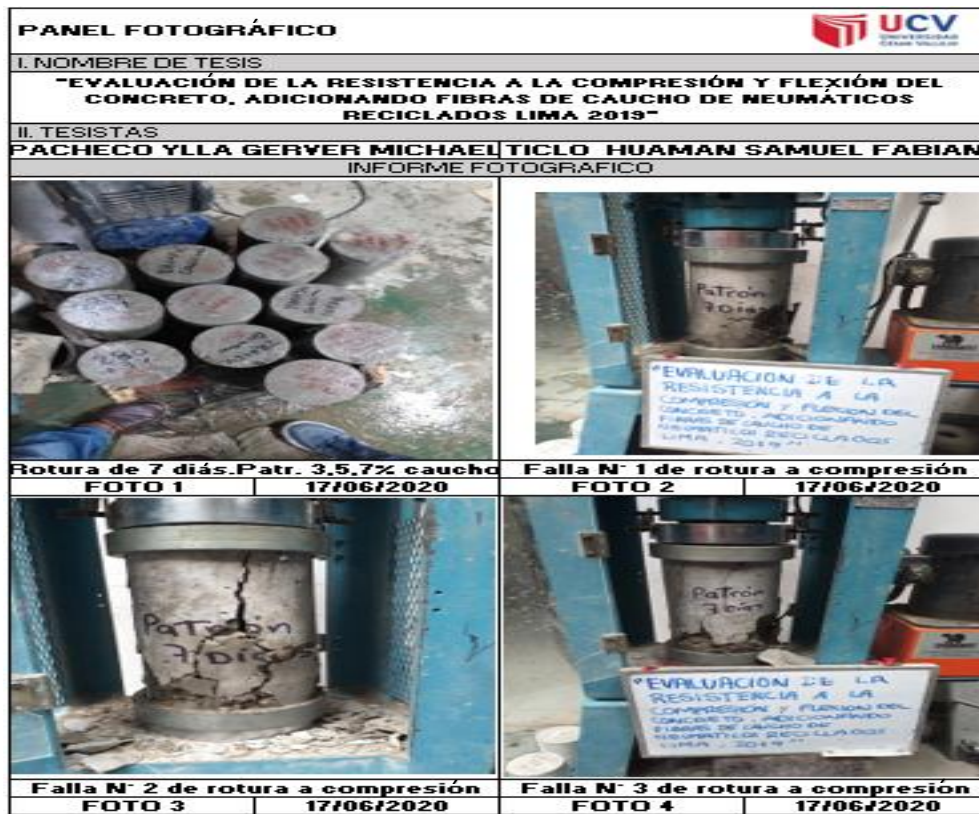
Panel Fotográfico 43: Rotura con 7% de caucho, resistencia a la compresión en 7 días
