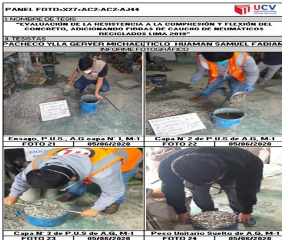
Panel Fotográfico 6: Ensayo de Peso Unitario Suelto de A.G
