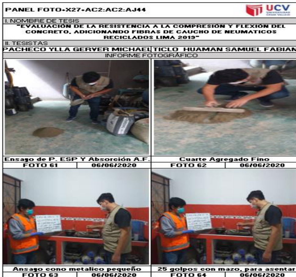
Panel Fotográfico 16: Ensayo de Peso Específico y Absorción de Agregado Fino
