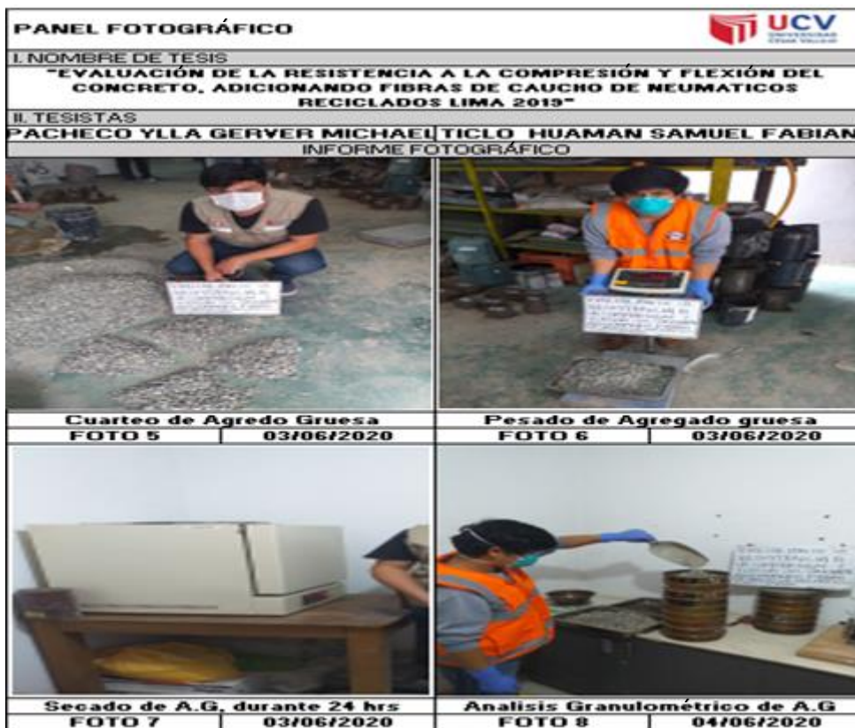
Panel Fotográfico 2: Ensayo de Análisis Granulométrico de Agregado Grueso
