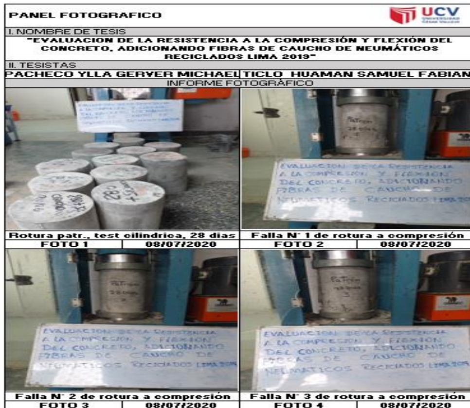
Panel Fotográfico 51: Rotura con 3% de caucho, resistencia a la compresión en 28 días
