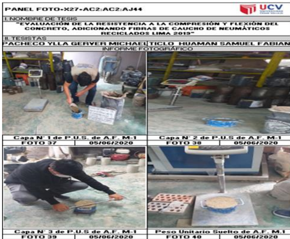
Panel Fotográfico 10: Ensayo de Peso Unitario de Agregado Fino.
