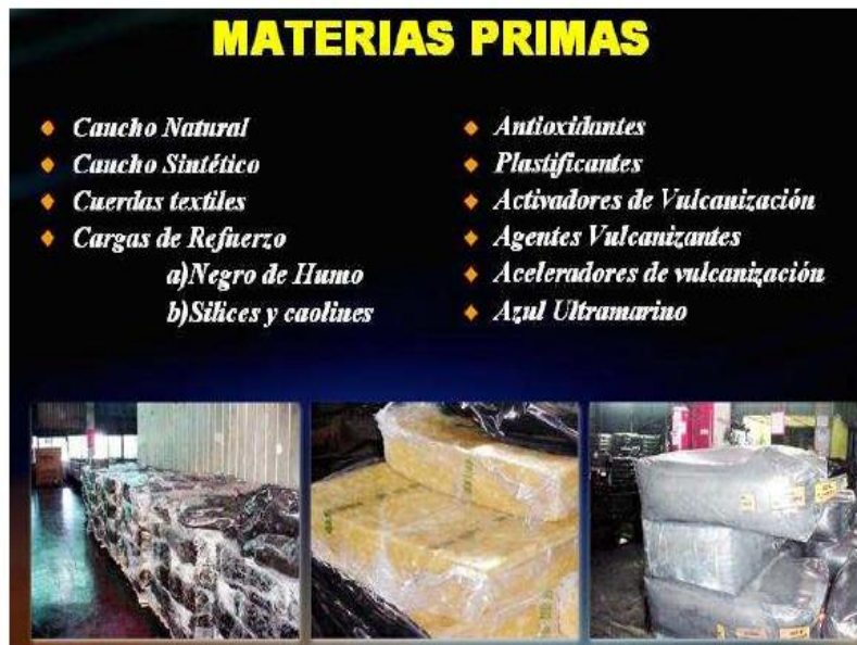
Figura 3 Componentes de un neumático
