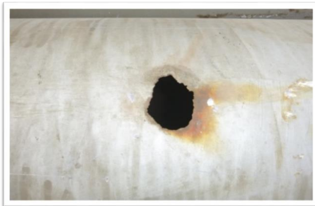
FIGURA 6: Orificio, por oxidación en línea de proceso de Ø16'''.
