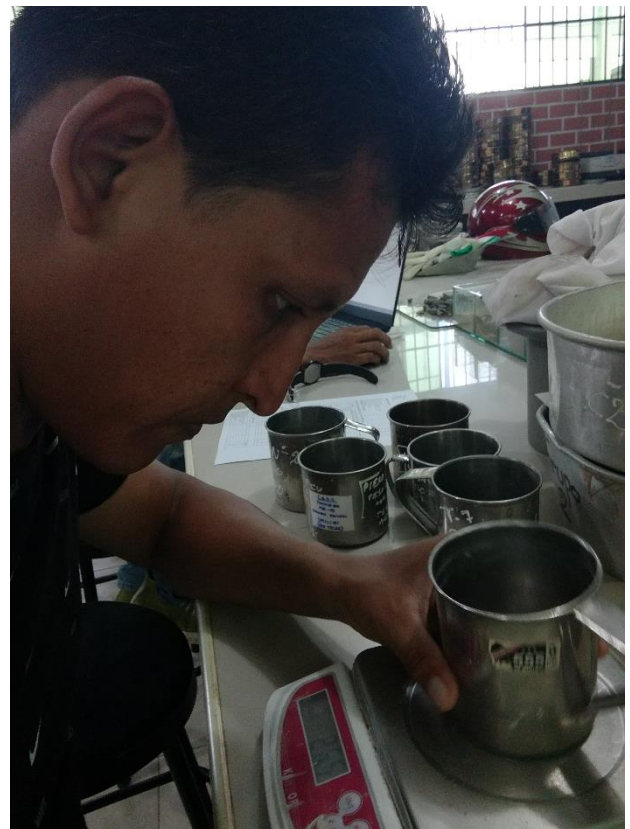
FOTO 06: En las imágenes se aprecia la realización del estudio de suelos, en este caso para determinar la granulometría y el contenido de humedad de la muestra extraída.
