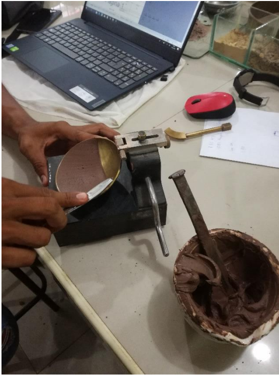
FOTO 07: Estudio de suelos para determinar en este caso el limite líquido con la casa grande y el peso unitario.
