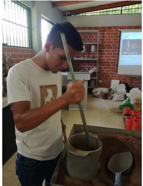
FOTO 07: Estudio de suelos para determinar en este caso el limite líquido con la casa grande y el peso unitario.
