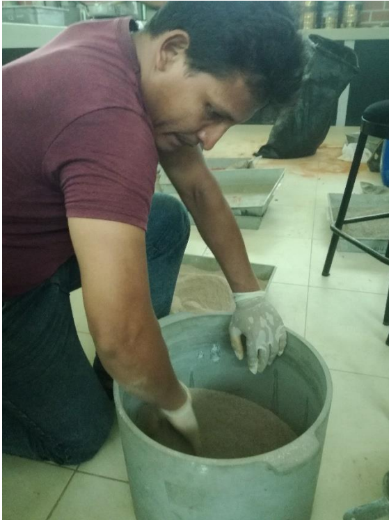
FOTO 08: En las imágenes se observa el mezclado del material al 10% y 15% de puliton, como también el envasado de las muestras en sacos de 5kg.
