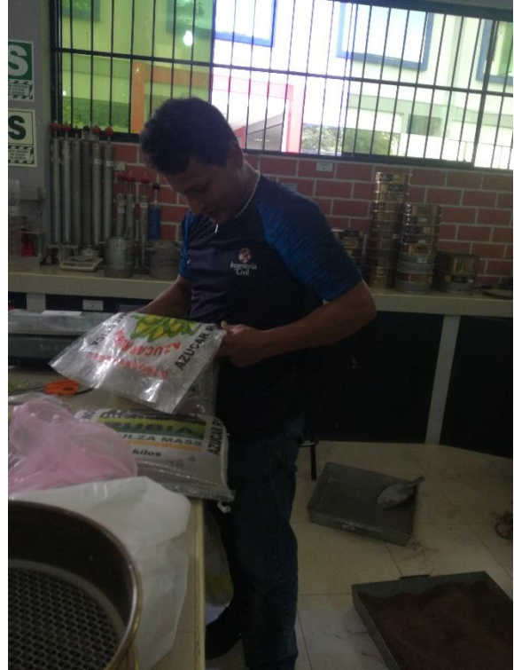
FOTO 08: En las imágenes se observa el mezclado del material al 10% y 15% de puliton, como también el envasado de las muestras en sacos de 5kg.
