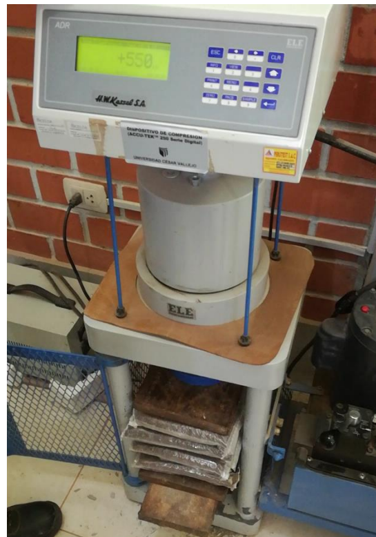
FOTO 10: En las dos imágenes de puede apreciar el colocado de los sacos de 5kg de las muestras, para que posteriormente se realice el ensayo de la resistencia a compresión.
