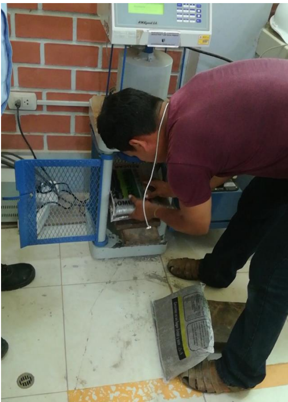
FOTO 10: En las dos imágenes de puede apreciar el colocado de los sacos de 5kg de las muestras, para que posteriormente se realice el ensayo de la resistencia a compresión.
