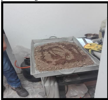
Figura 15: Adición del contenido óptimo de agua a la muestra natural.
