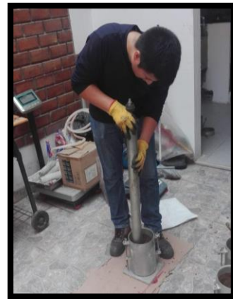
Figura 16: Compactación de las capas.
