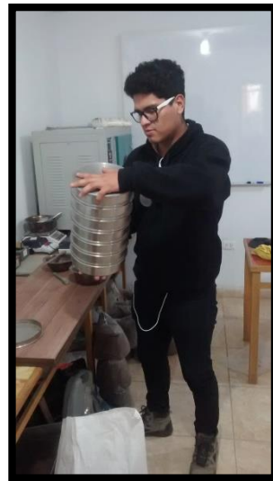
Figura 3: El autor realizando el ensayo de granulometría, por los distintos tamices – suelo natural.
