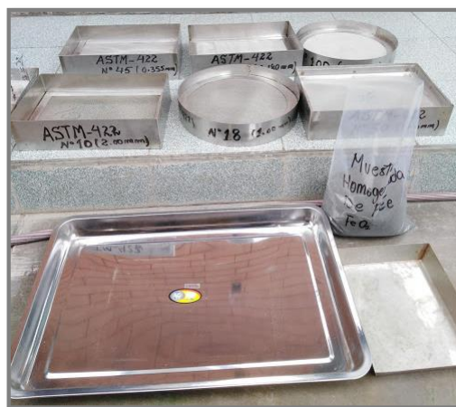
Figura 2. 5. Tamizado de la muestra
