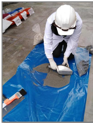
Figura 2. 4. Técnica del cuarteo
