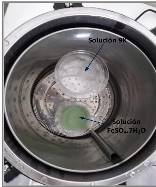
Figura 2. 8. Esterilización de las soluciones por autoclave
