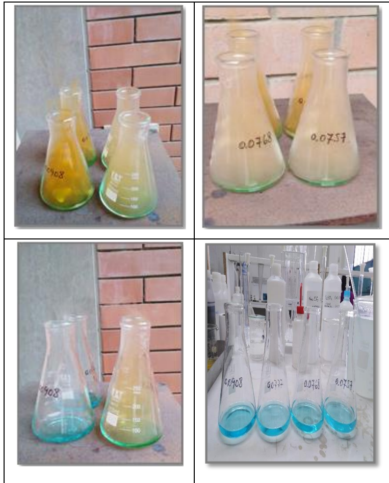
Figura 2. 6. Sulfatación de la muestra
