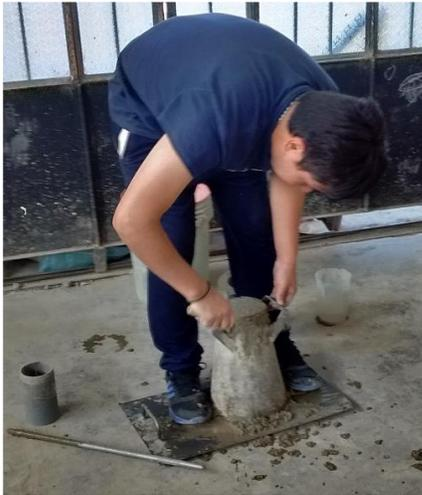
*Figura 10: ensayo de trabajabilidad*
