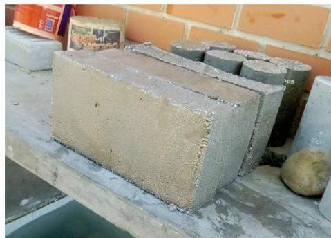
*Figura 12: Bloques de concreto de 9 x 19 x 39 cm*
