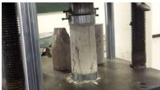
*Figura 8:* Prueba de resistencia a la compresión
