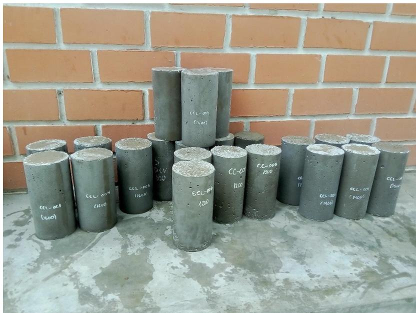
Fotografía 4: probetas cilíndricas
