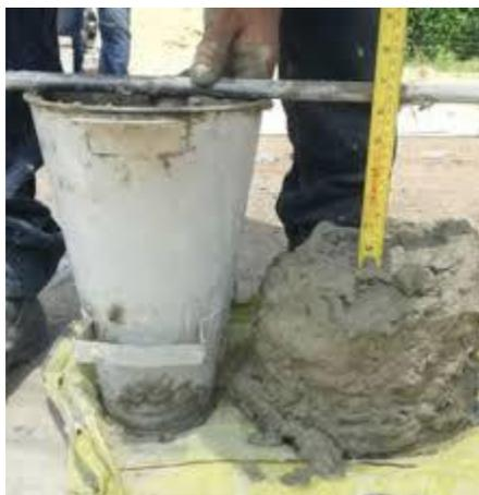
*Figura 9: Ensayo de Cono de Abrams*
