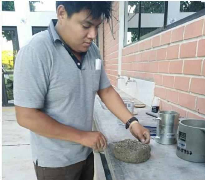
Fotografía 3: Ensayo del asentamiento
