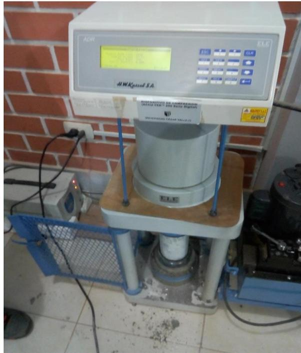
Fotografía 5: Resistencia a la compresión de probetas
