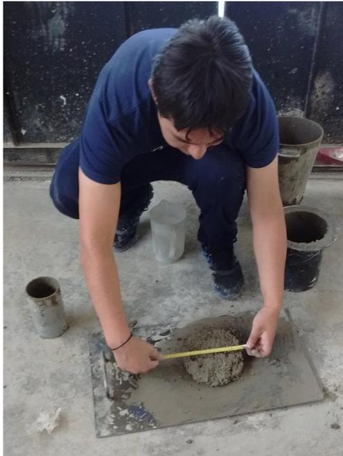
Fotografía 9: Ensayo de asentamiento
