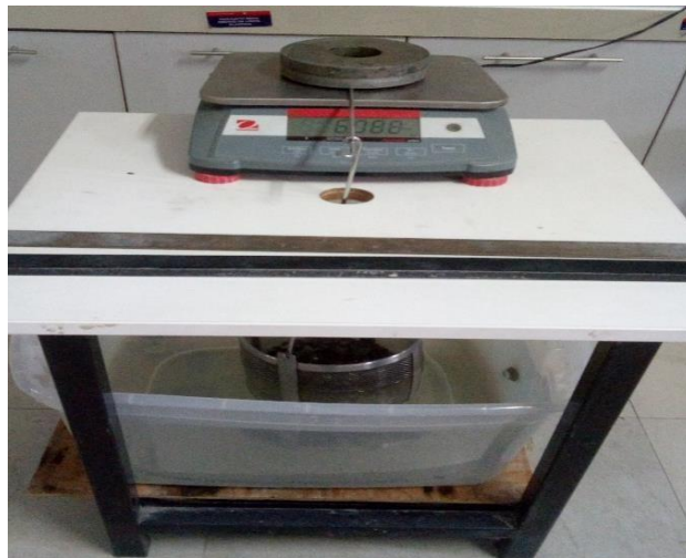
Figura 4.12. Pesado del agregado grueso sumergido totalmente
