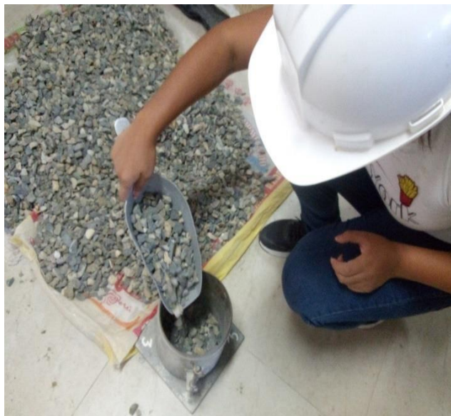
Figura 4.13. Colocación del agregado grueso en el molde.
