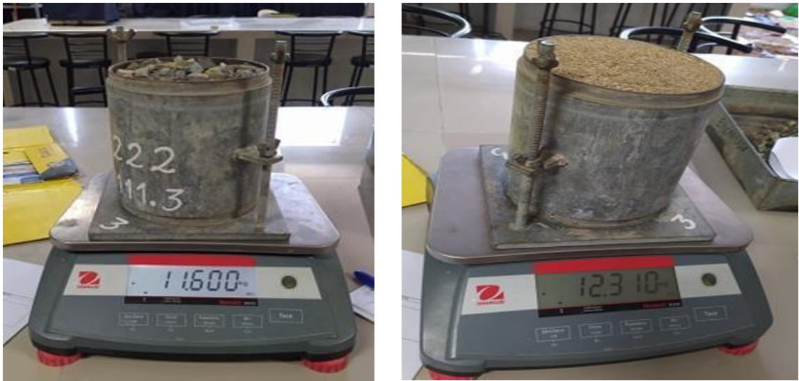
Figura 4.14. Peso de molde más agregado grueso y fino
