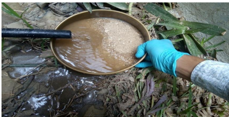
Figura 4.4. Lavado de material fino mediante la malla N°200
