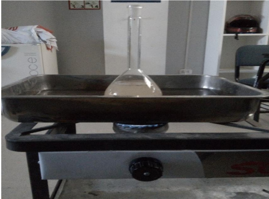
Figura 4.9. Picnómetro, agua y agregado fino puesto en cocina hasta llegar a su punto de ebullición.
