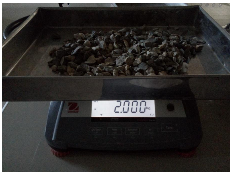
Figura 4.10. Peso de una de las muestras de agregado grueso de ½”.
