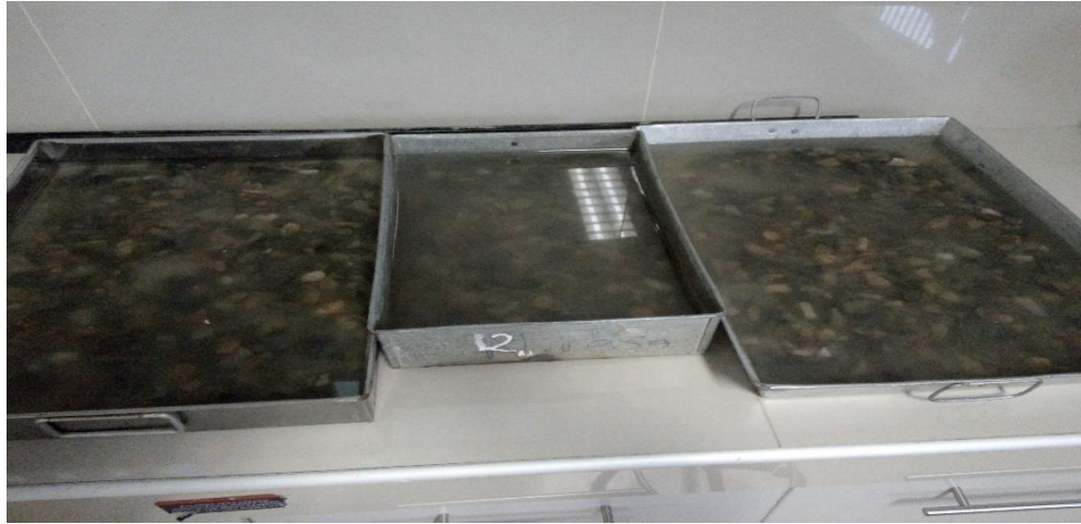
Figura 4.11. Muestras de agregado grueso sumergidas en recipientes con agua.
