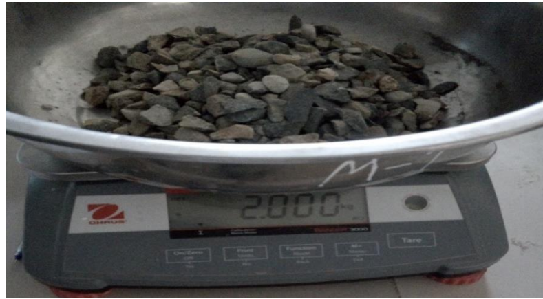
Figura 4.16. Pesado de la muestra de agregado grueso
