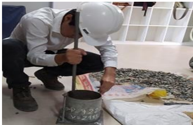
Figura 4.15. Aplicación de los 25 golpes en la primera capa para agregado grueso.
