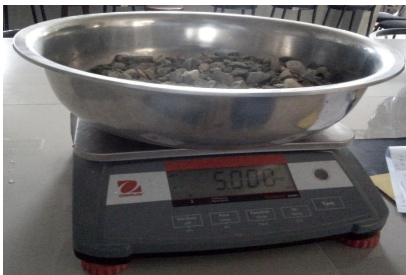
Figura 4.5. Peso de la muestra de agregado grueso de 1/2"
