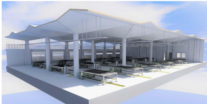
PERSPECTIVA INTERIOR DE SECTOR DE PRODUCCIÓN - COBERTURAS CON MONTANTES Y BANDEJA PORTACABLES
