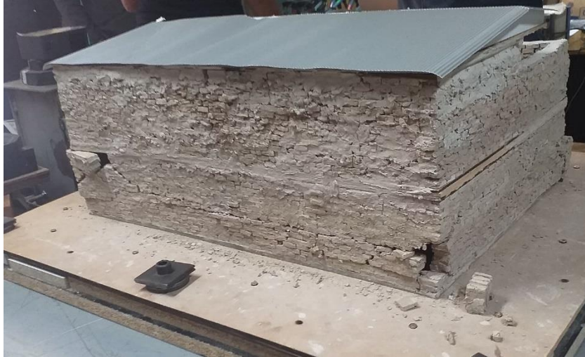
Figura 93. Desprendimiento de ladrillos en la esquina inferior trasera del espécimen de adobe sin refuerzo. Fuente: Imagen propia, 2019
