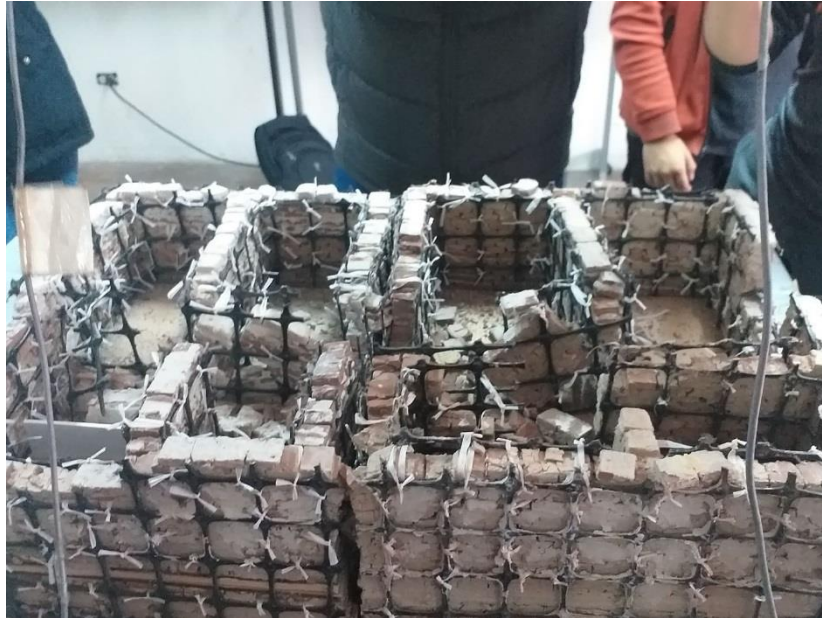
Figura 117. se aprecia el desprendimiento de bloques de adobe, algunos muros interiores colapsados en el segundo nivel del espécimen reforzado con geomalla. Fuente: Imagen propia, 2019
