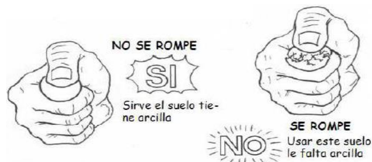
Figura 6. Prueba sobre la presencia de arcilla.
