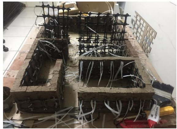
Figura 43. Asentado de bloques (estructura reforzada). Fuente: Imagen propia, 2019
