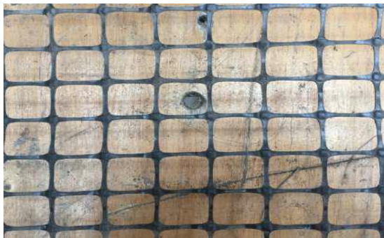
Figura 24. Geomalla biaxial. Fuente: Cárdenas y Luna, 2017
