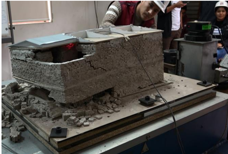
Figura 96. Rotura en diagonal del muro trasero del nivel 2 y colapso de los muros exteriores traseros del primer nivel del espécimen de adobe sin refuerzo. Fuente: Imagen propia, 2019
