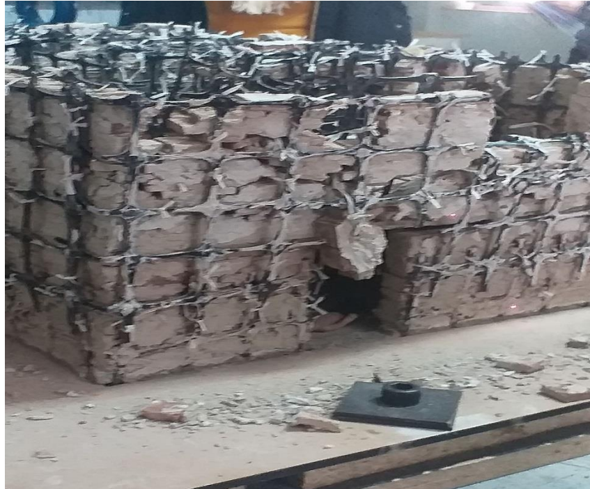
Figura 121. se aprecia desprendimientos de estratos de muros delanteros en el segundo nivel del espécimen reforzado con geomalla. Fuente: Imagen propia, 2019
