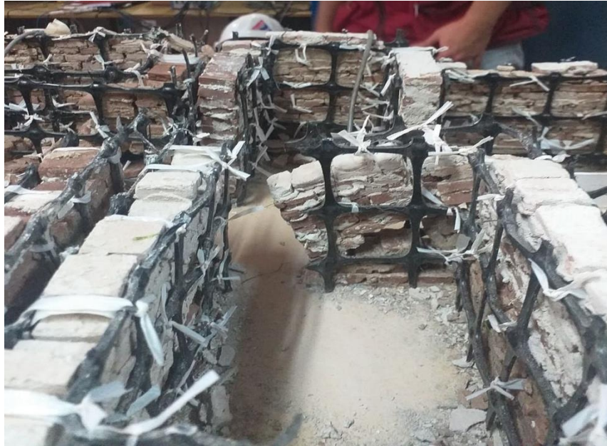
Figura 119. se aprecia muro apuntado del colapso-segundo nivel del espécimen reforzado con geomalla. Fuente: Imagen propia, 2019
