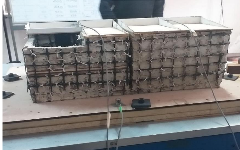
Figura 102. Conexión de los sensores sobre la base del espécimen y el techo. Fuente: Imagen propia, 2019
