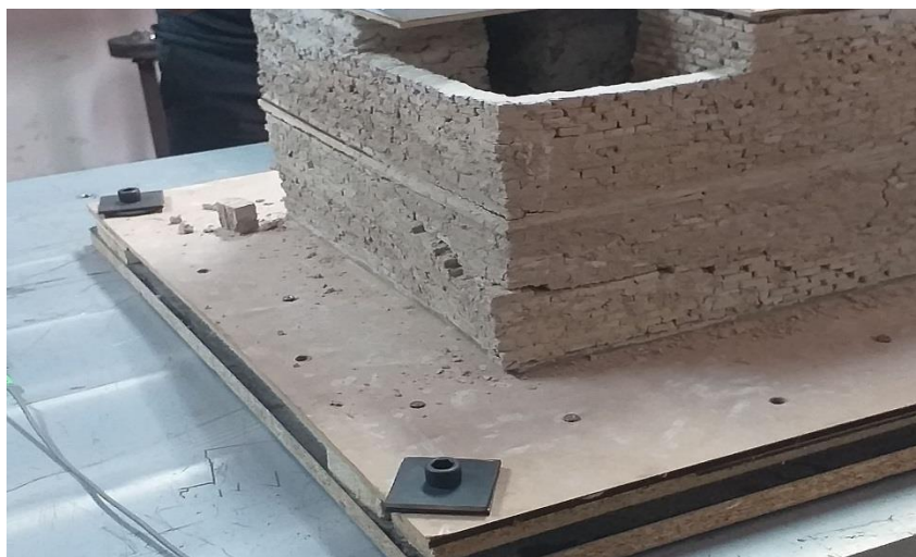
Figura 92. Rotura y desprendimiento de la esquina inferior trasera del espécimen de adobe sin refuerzo. Fuente: Imagen propia, 2019
