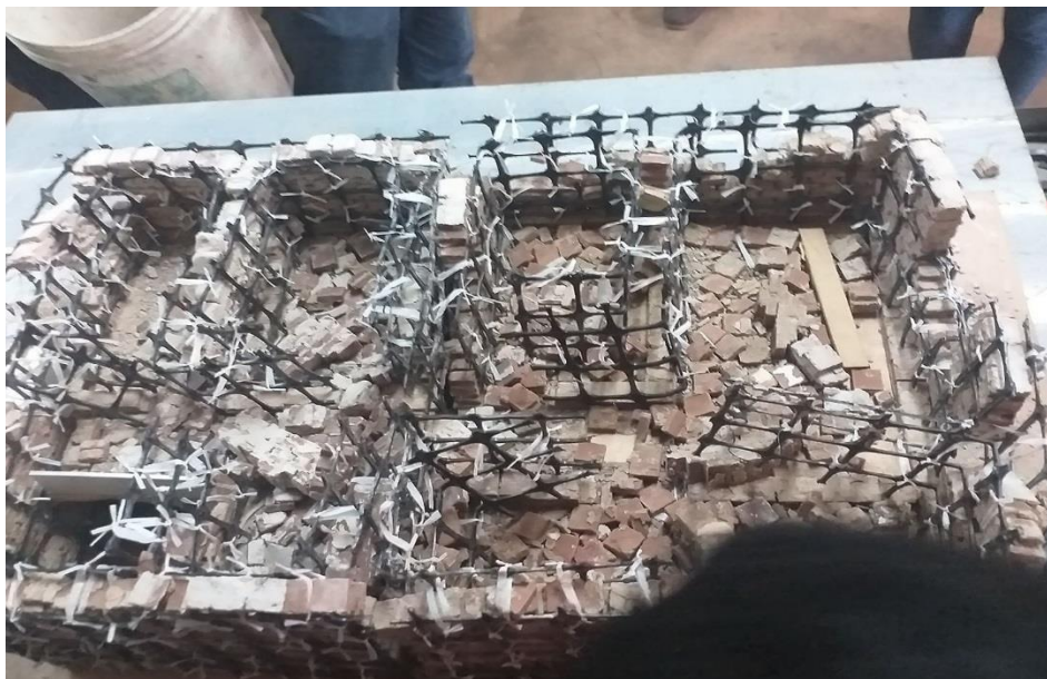
Figura 126. se aprecia muros interiores colapsados en el segundo nivel del espécimen reforzado con geomalla. Fuente: Imagen propia, 2019
