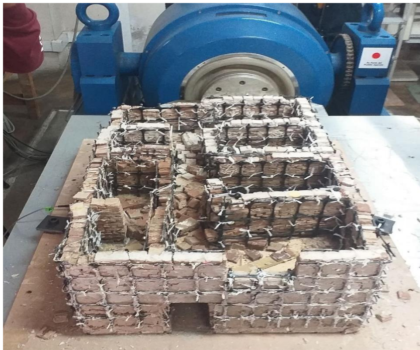
Figura 117. se aprecia el desprendimiento de bloques de adobe, algunos muros interiores colapsados en el segundo nivel del espécimen reforzado con geomalla. Fuente: Imagen propia, 2019
