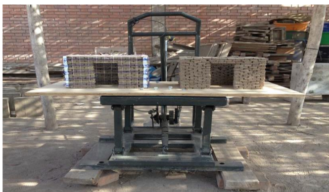
Figura 31. Mesa de vibración a escala reducida portátil de la PUCP.
