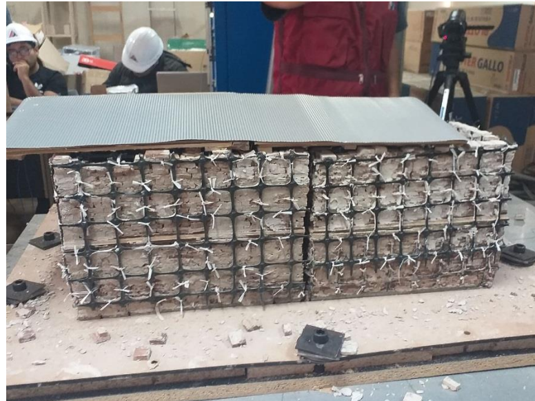
Figura 115. se aprecia el desprendimiento del techo espécimen reforzado con geomalla.
