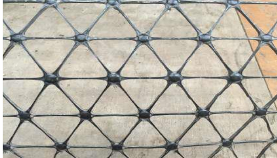
Figura 25. Geomalla triaxial. Fuente: Cárdenas y Luna, 2017
