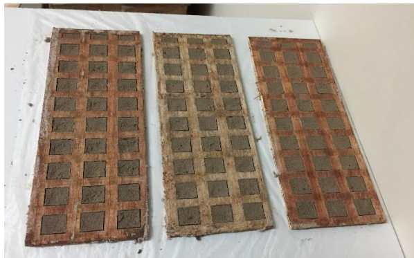
Figura 38. Moldes de los bloques de adobe. Fuente: Imagen propia, 2019
