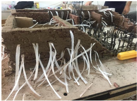
Figura 43. Asentado de bloques (estructura reforzada). Fuente: Imagen propia, 2019
