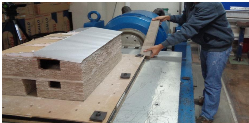
Figura 82. Impulso sobre el Especimen. Fuente: Imagen propia, 2019
