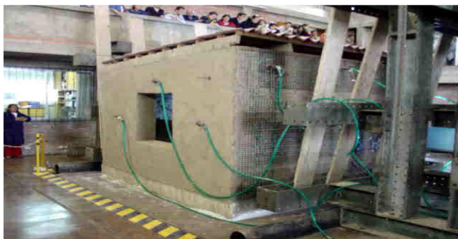
Figura 30. Plataforma de simulación sísmica a escala natural.
