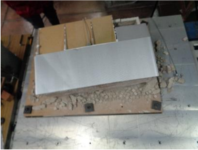
Figura 99. Efecto de torsión, la estructura se desprende de su plano. Fuente: Imagen propia, 2019
