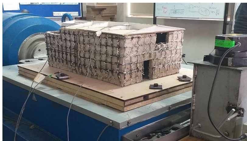
Figura 100. Estructura reforzada con geomalla. Fuente: Imagen propia, 2019
