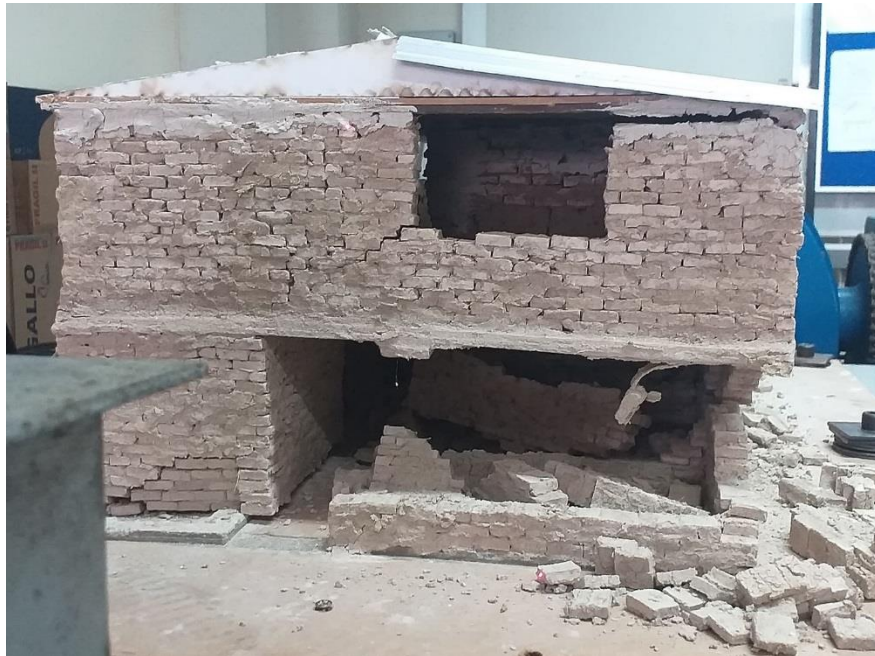
Figura 97. Rotura en diagonal del muro del nivel 2, colapso y destrucción de muros laterales en el primer piso. El modelo se inclina hacia un lado por falta de apoyos. Fuente: Imagen propia, 2019
