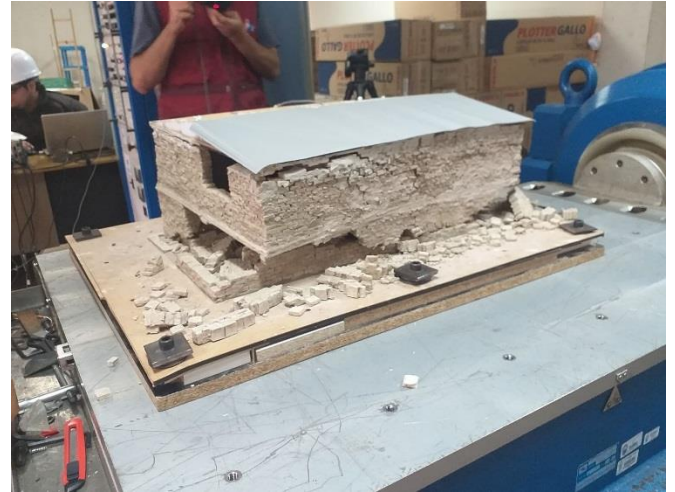
Figura 99. Efecto de torsión, la estructura se desprende de su plano. Fuente: Imagen propia, 2019
