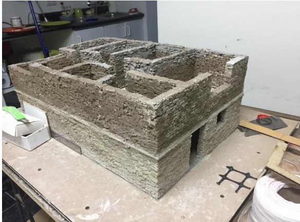
Figura 48. Colocación de techos, estructura sin refuerzo. Fuente: Imagen propia, 2019
