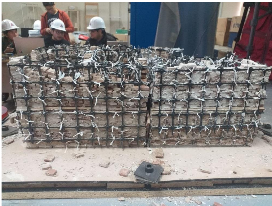
Figura 121. se aprecia desprendimientos de estratos de muros delanteros en el segundo nivel del espécimen reforzado con geomalla. Fuente: Imagen propia, 2019
