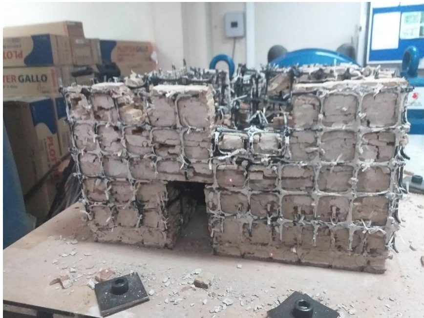
Figura 119. se aprecia muro apuntado del colapso-segundo nivel del espécimen reforzado con geomalla. Fuente: Imagen propia, 2019
