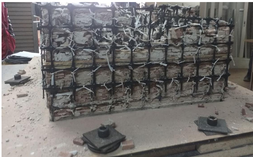
Figura 123. se aprecia muros traseros colapsados en el segundo nivel del espécimen reforzado con geomalla. Fuente: Imagen propia, 2019
