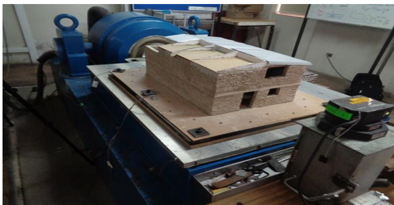
Figura 79. Especimen sin reforzamiento. Fuente: Imagen propia, 2019
