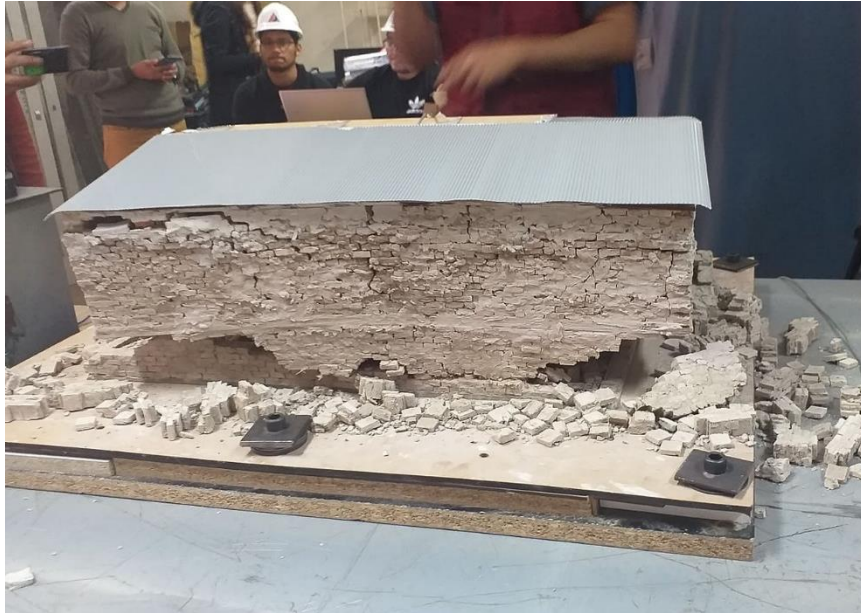
Figura 97. Rotura en diagonal del muro del nivel 2, colapso y destrucción de muros laterales en el primer piso. El modelo se inclina hacia un lado por falta de apoyos. Fuente: Imagen propia, 2019
