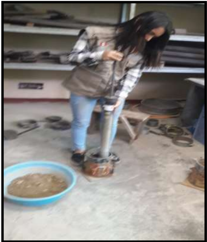
Descripción: Ensayo de Proctor modificado
