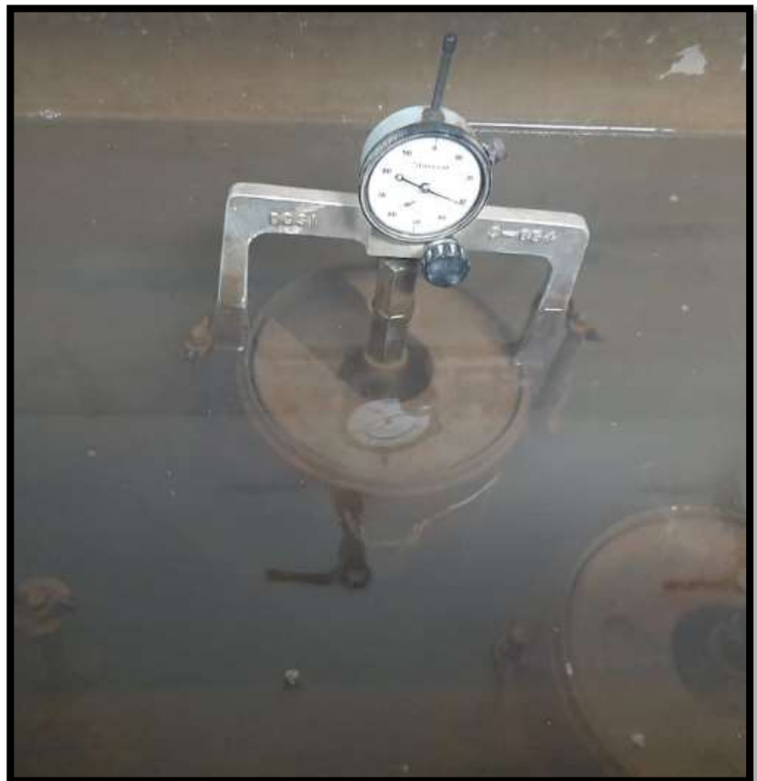
Descripción: Ensayo de CBR
