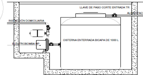
DETALLE CISTERNA DE POLIETILENO ROTOPLASS ESCALA 1/20
