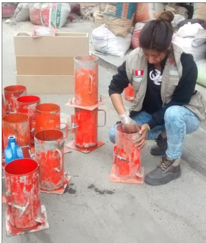
Figura 44. Engrasando las probeta y las vigas una vez estén limpios
