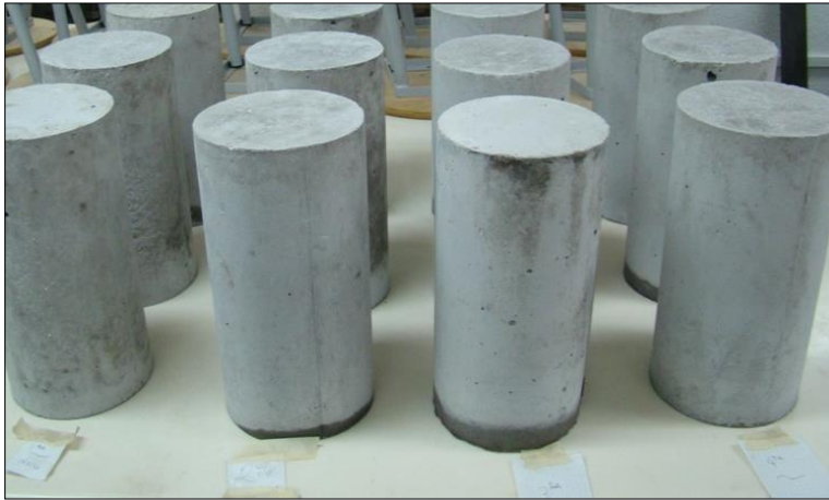
Figura 50. Desencofrado de las probetas
