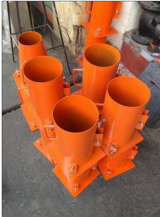
Figura 43. Probetas para el ensayo a compresión
