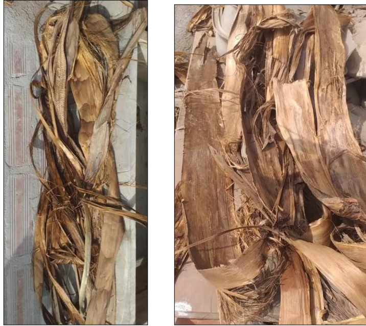
Figura 38. Secado de las vainas hasta que no estén quebradizas
