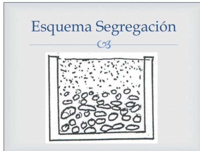
Figura 3. Segregación de agregados
