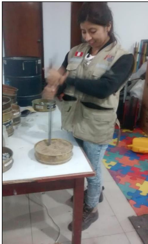
Figura 31. Compactación del agregado fino
