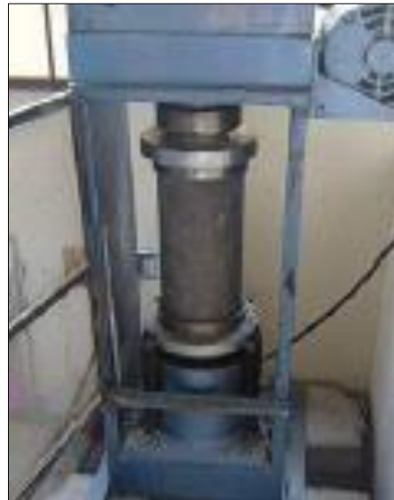
Figura 54. Ensayo a compresión
