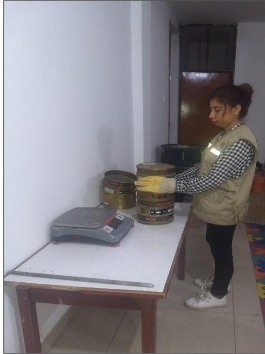
Figura 24. Colocando los tamices según el tipo de malla
