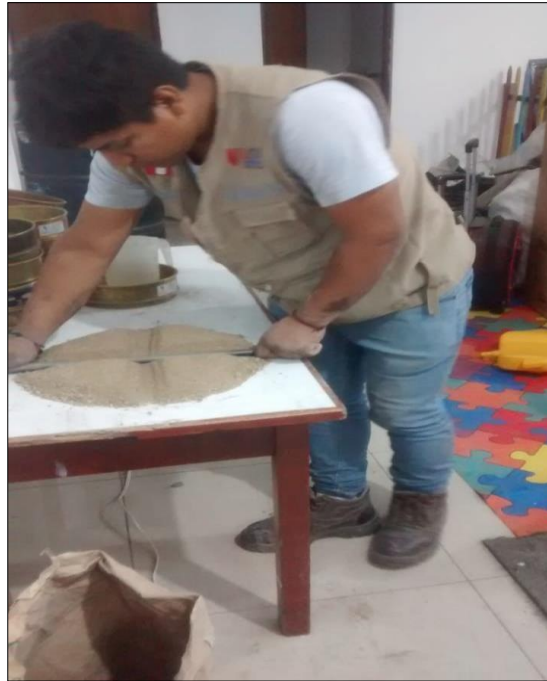
Figura 20. Cuarteo de la muestra de agregado fino
