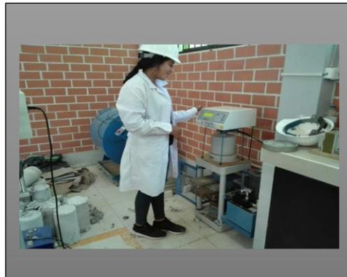
Tesista verificando la rotura de adoquín
