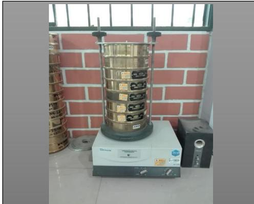
Ensayo granulométrico de la arena
