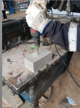
Perforación de adoquín para introducir el sensor de temperatura
