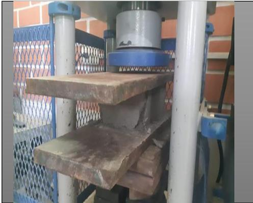
Rotura de adoquín en la prensa hidráulica
