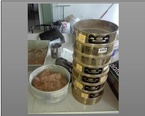
Ensayo granulométrico de la fibra
