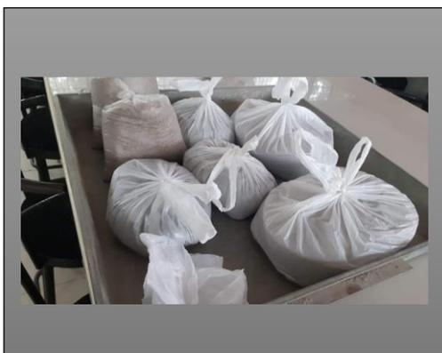
Dosificación de adoquines adicionando fibra de coco
