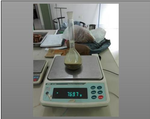
Ensayo de absorción de la arena
