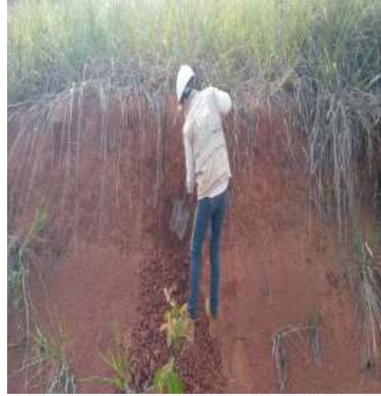
Imágenes N° 01 – 02: Extracción de la muestra para ser conducido a laboratorio para realizar los ensayos requeridos.
