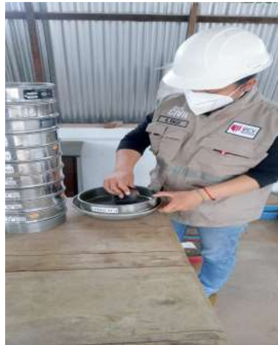
Imágenes N° 03 – 04: Realizando análisis granulométricos a los materiales.
