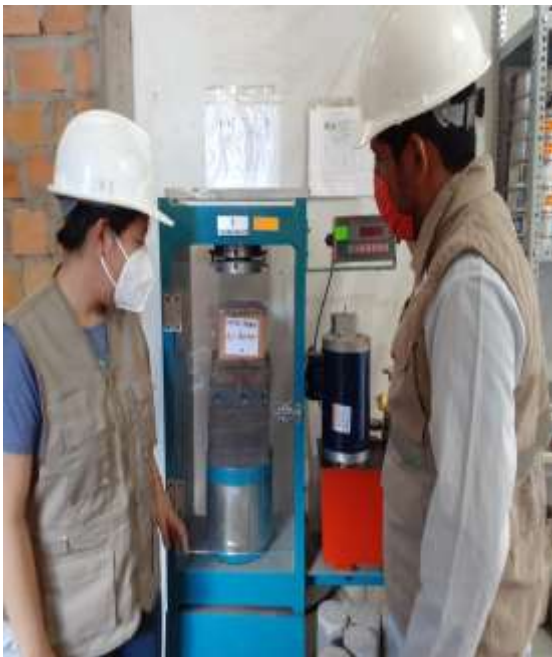
Imágenes N° 10 – 11: Podemos observar la realización de roturas de los bloques de adobe con la incorporación de PET y sin la incorporación de PET.
