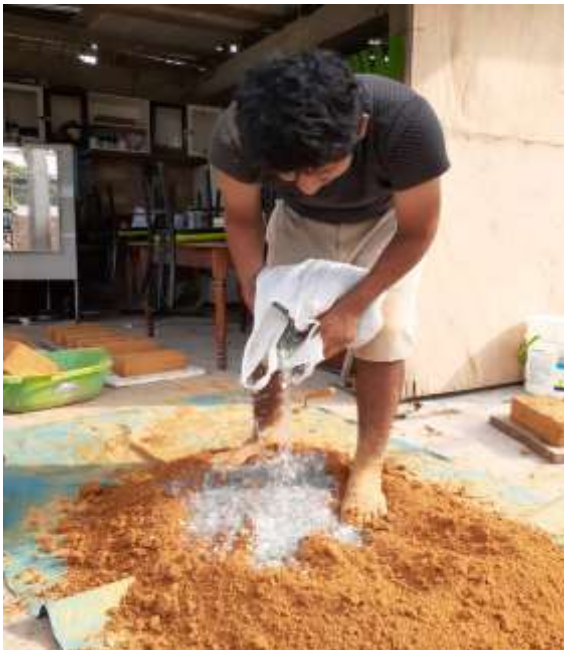
Imágenes N° 07 – 08: Se puede apreciar la elaboración de los bloques de adobe con PET y sin PET.
