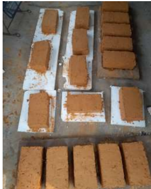
Imágenes N° 07 – 08: Se puede apreciar la elaboración de los bloques de adobe con PET y sin PET.
