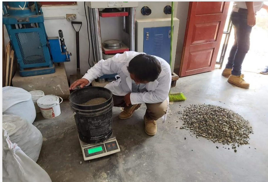
Pesado del material para hacer el ensayo granulométrico
