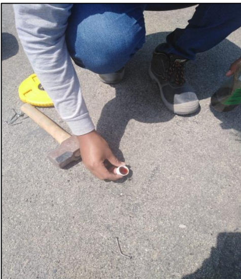
Se observa en las imágenes la entrada del camión volquete a la pista de aterrizaje, así como su ubicación respectiva. Además, se observa el ensamblaje de la viga Benkelman, la perforación del pavimento, el llenado con aceite industrial y la toma de temperatura correspondiente.
