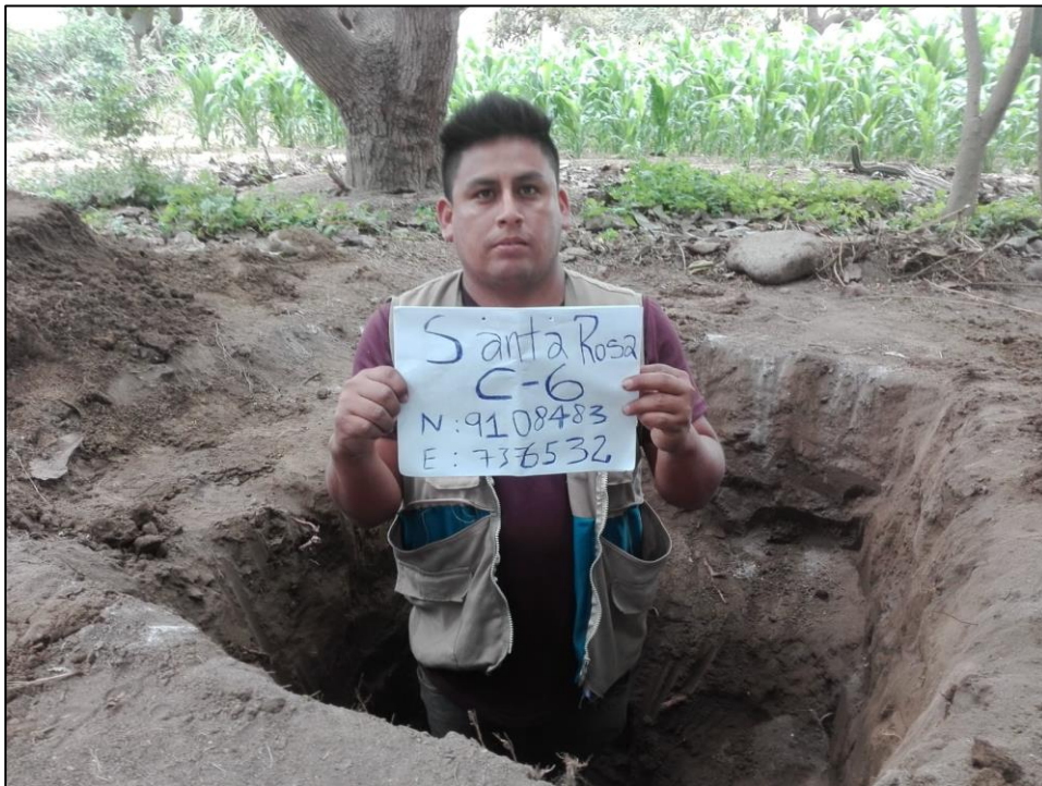
Figura 25 : Calicata N°06 para el estudio de suelos
