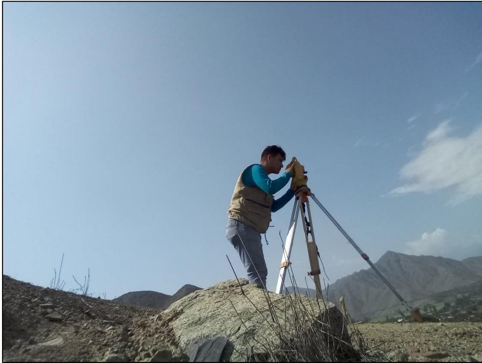
Figura 24 : Levantamiento topográfico con la estación total
