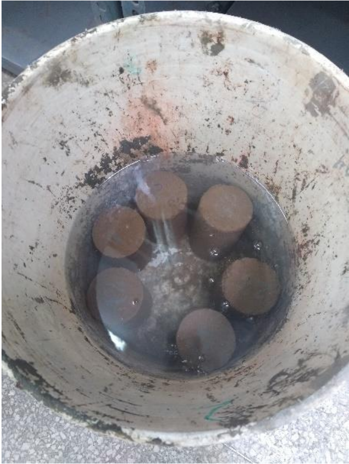
Muestras sumergidas en agua antes de realizar el ensayo a compresión
