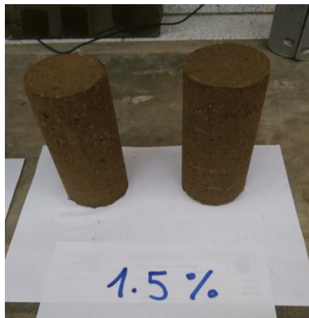
Figura 19: Probeta con dosificación de 1.5 % de cemento
