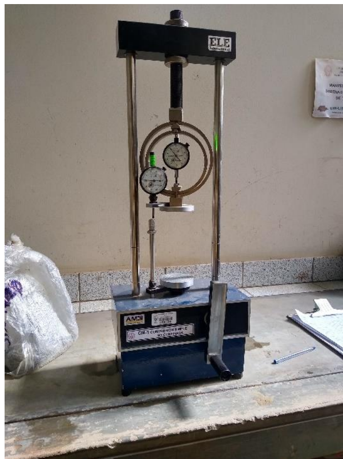
Equipo con el que realizo el ensayo a compresión no confinada
