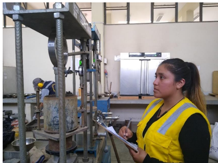
Figura 15: Visualización de la toma de datos para el ensayo de C.B.R.
