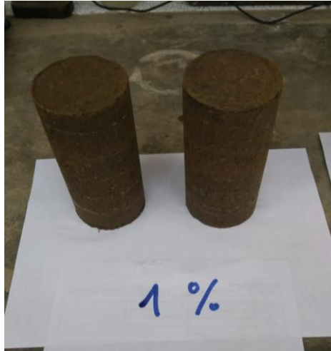
Figura 18: Probeta con dosificación de 1% de cemento
