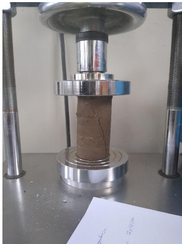
Primera falla de las probetas
