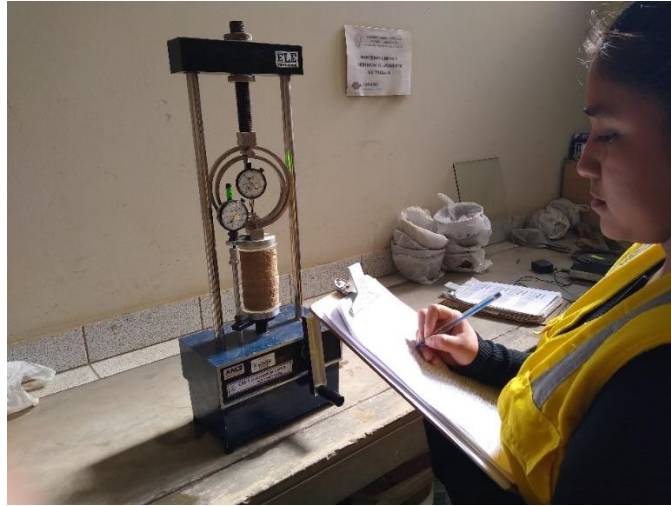
Figura 17: Toma de datos para el ensayo de resistencia a la compresión no confinada
