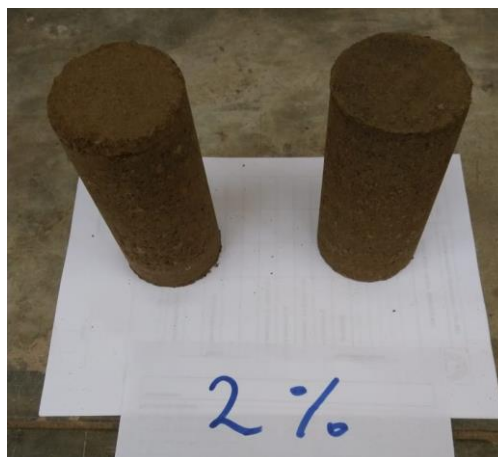
Figura 20: Probeta con dosificación de 2% de cemento
