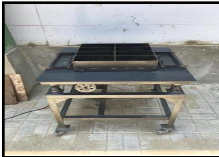
**FIGURA 29.** MESA VIBRADORA
