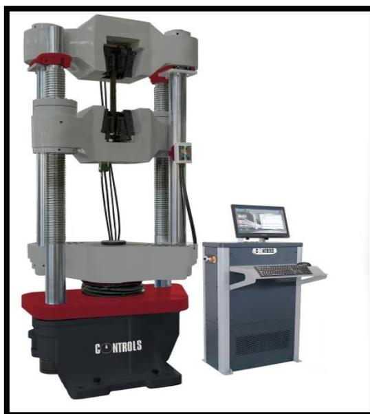
**FIGURA 22.** PRENSA UNIVERSAL VERSA TESTER
