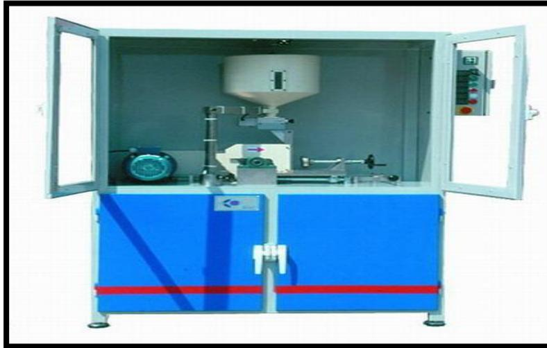
**FIGURA 24.** MÁQUINA DE ENSAYO PARA RESISTENCIA AL DESGASTE
