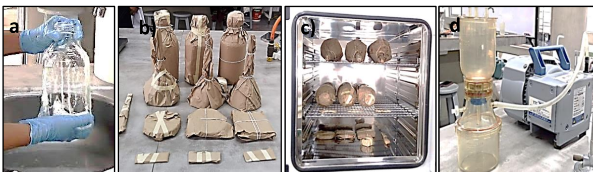
Figura 1. En el tratamiento de la muestra de un método pasivo, primero se procede al lavado del dispositivo y los materiales, luego se b) cubren para su posterior c) desinfección en la estufa, una vez recolectadas las muestras se filtran en una bomba de vacío
