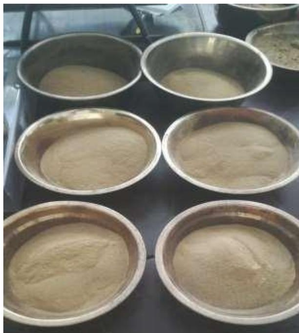
Figura 1.31 Muestra después del secado al horno
