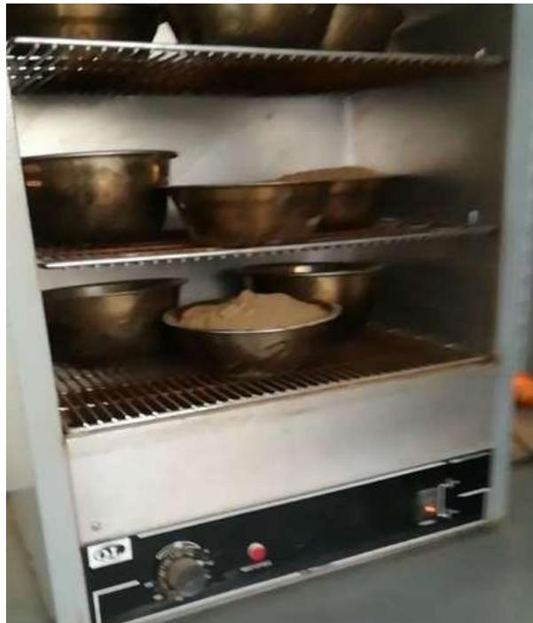
Figura 1.47. Horno con muestra en tara
