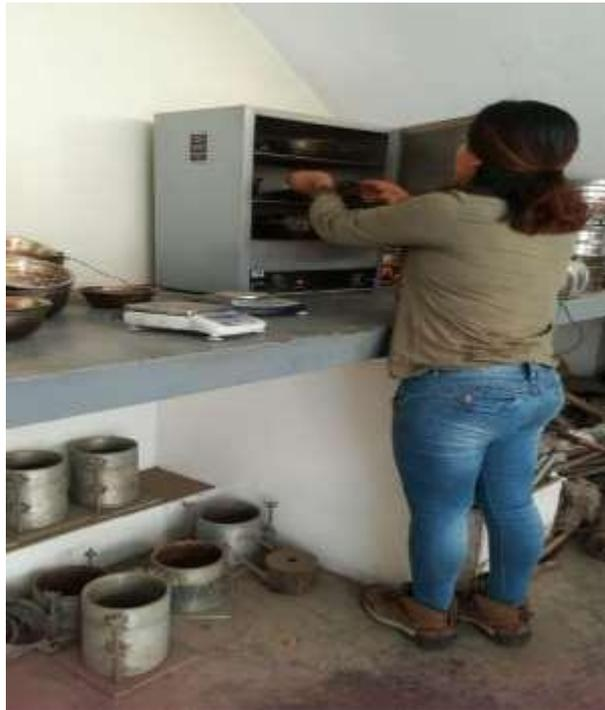
Figura 1.30 Llevando al horno por 24 horas
