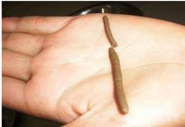
Figura 1.49 Rollitos de muestra – Límite plástico
