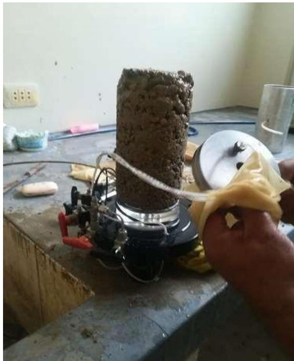
Figura 1.53 Especimen inalterado
