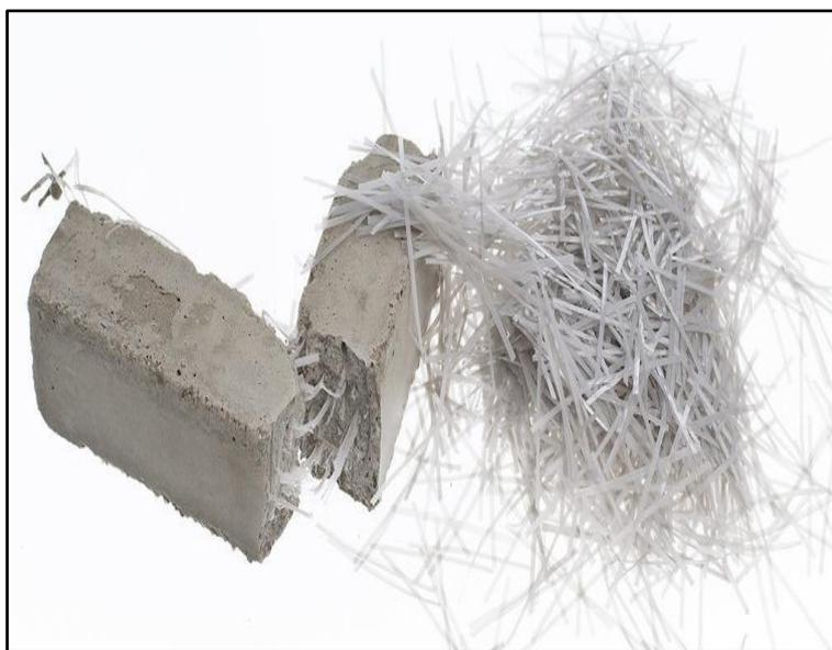
*Figura 1. Concreto con fibra PET*
