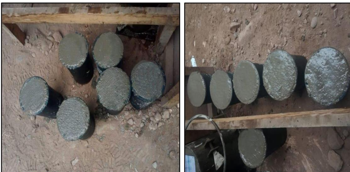
*Figura 36. Probetas cilíndricasterminadas*
