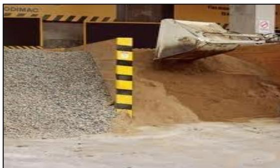
*Figura 4.* Almacenamiento de agregados
