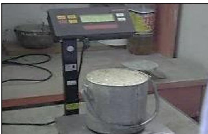
*Figura 22.* Cálculo del peso unitario para el agregado fino
