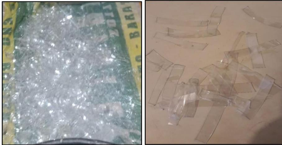
Figura 18. Fibras PET procesadas
