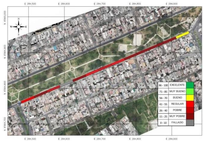
Figura 10. Estado de la vía en general
