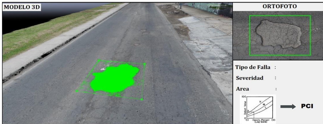
Figura 2: Identificación y cuantificación de deterioros mediante una ortofoto
