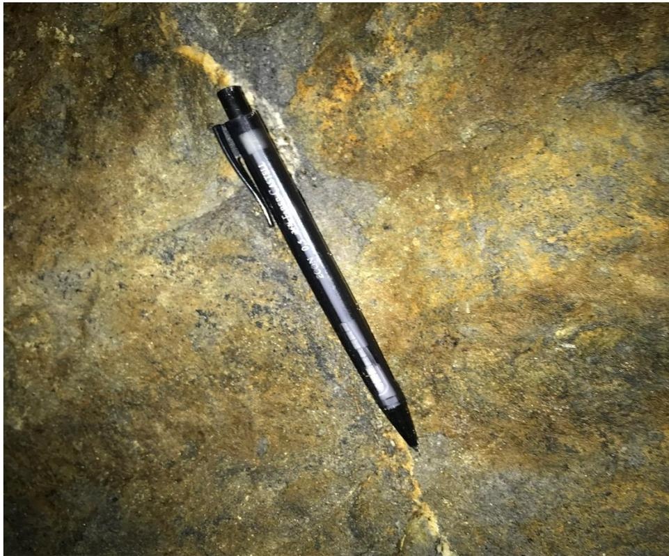
*Figura 19: Relleno de la discontinuidades en la galería principal del nivel 2650.*
