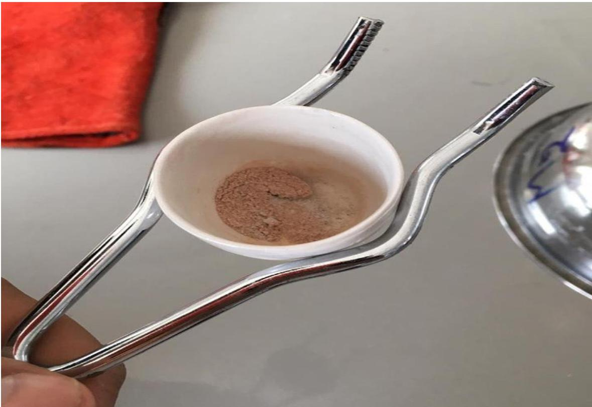
Figura 26: Muestra extraída después de ser sometida a la mufla.
