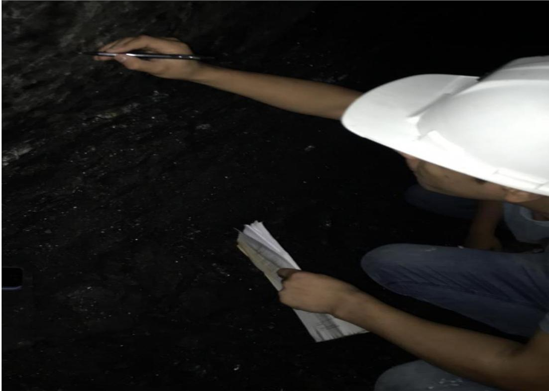
*Figura 23:* Estudio para determinar la rugosidad de las discontinuidades en la galería principal.
