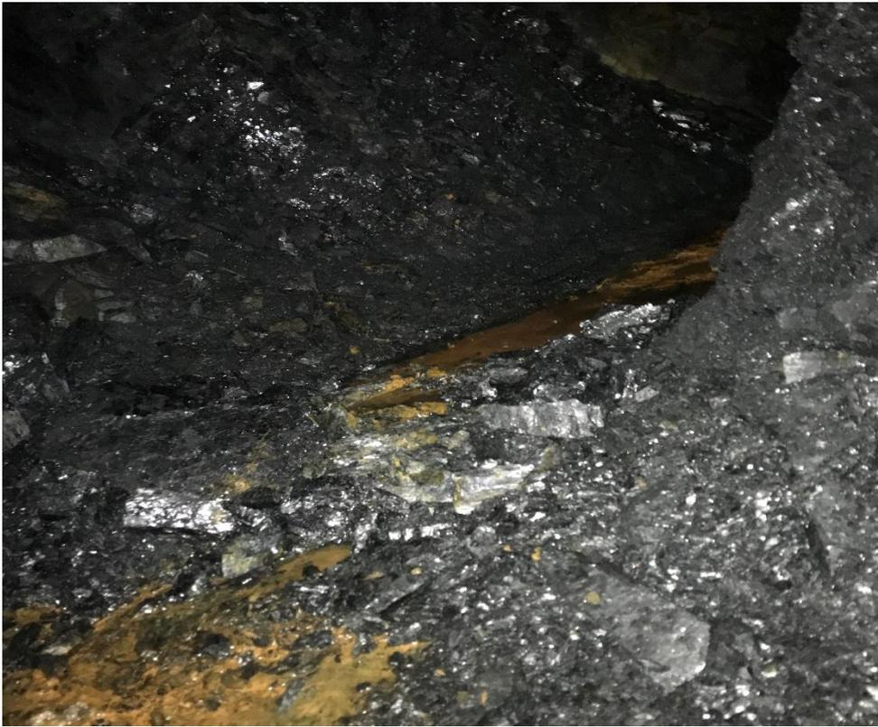
*Figura 21:* Flujo de agua en los puntos críticos en la galería principal del nivel 2650.
