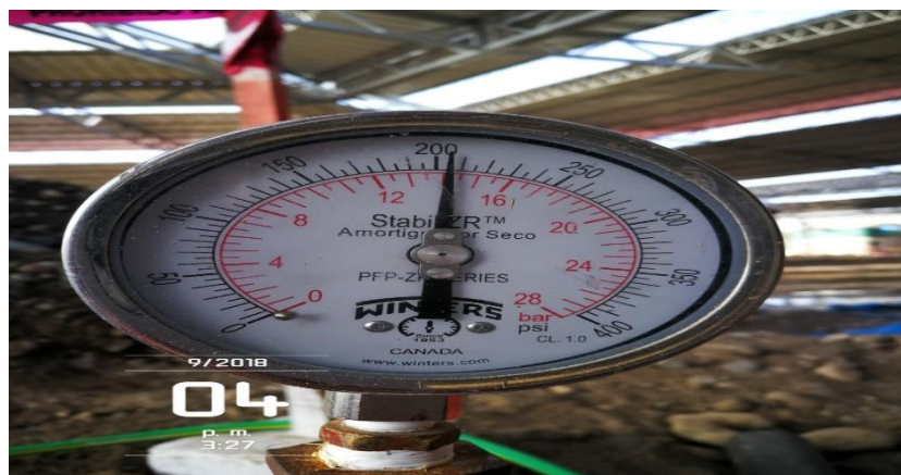
Figura 44. Medición de presión de las de tubería HDPE con un manómetro en el Proyecto Mercado de Chancay. (Fuente: Tomada por parte propia).
