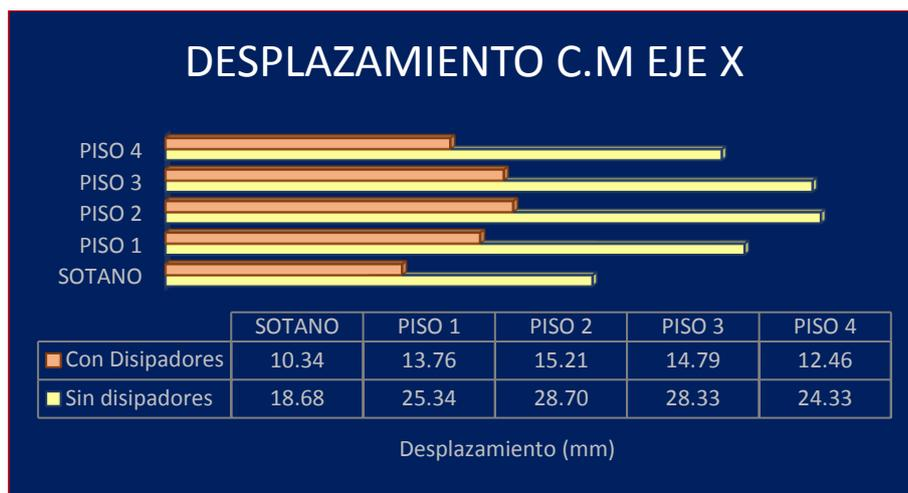
Fig. 10: Desplazamiento de C.M con y sin disipadores en X
