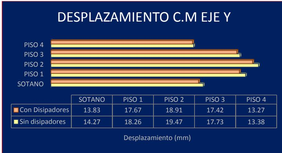
Fig. 11: Desplazamiento de C.M con y sin disipadores en Y
