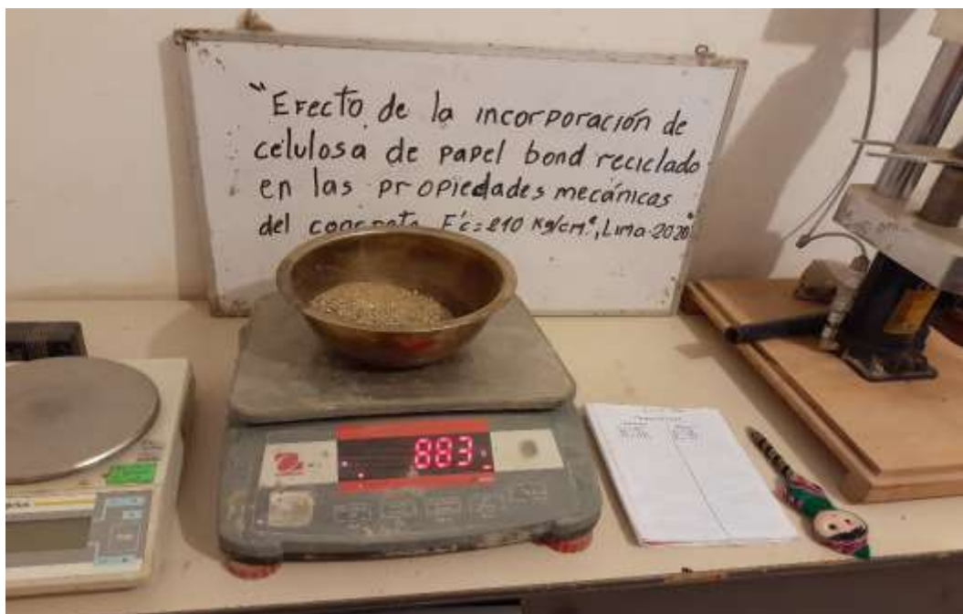
Figura: pesado del agregado fino para el ensayo granulométrico
