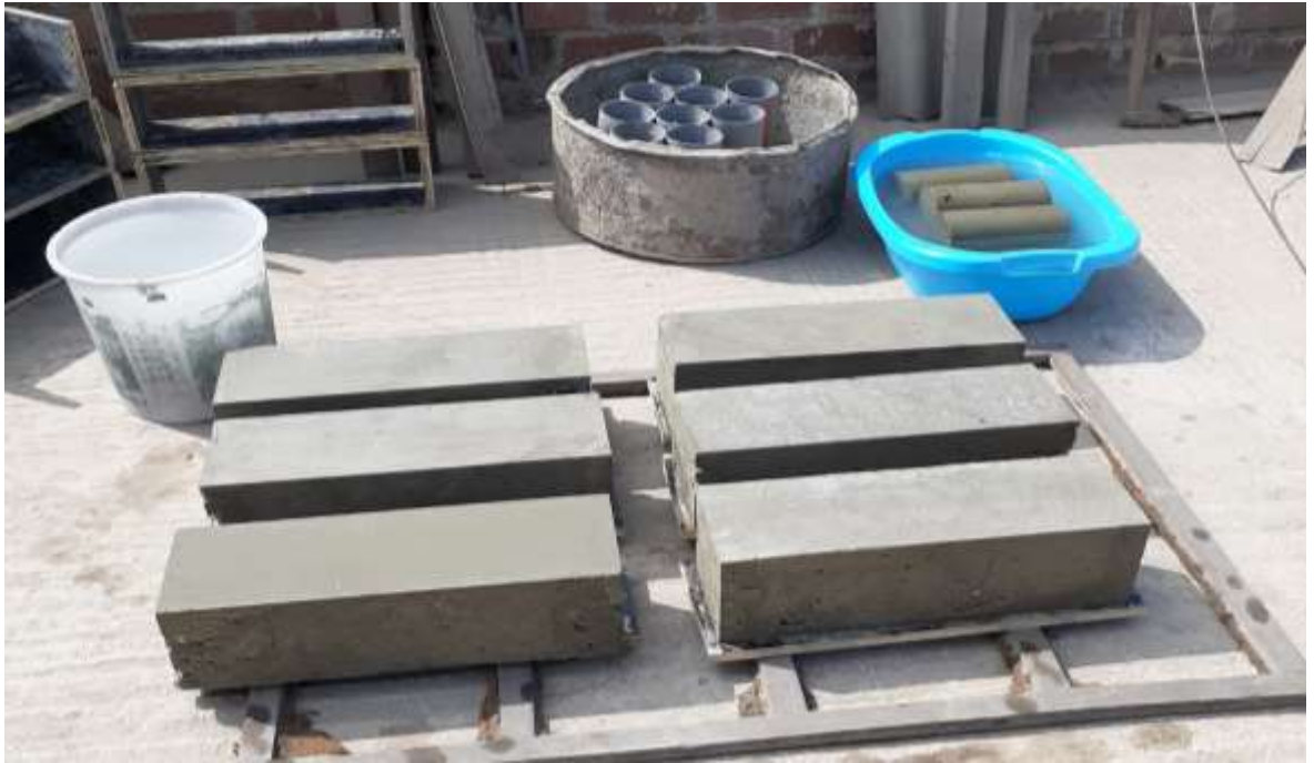
Figura: vista de la 6 vigas y 9 probetas patrón
