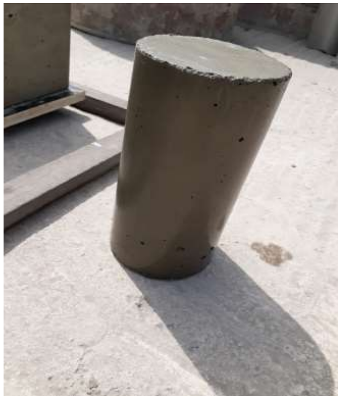
Figura: las dimensiones de las probetas son de 4" x 8"
