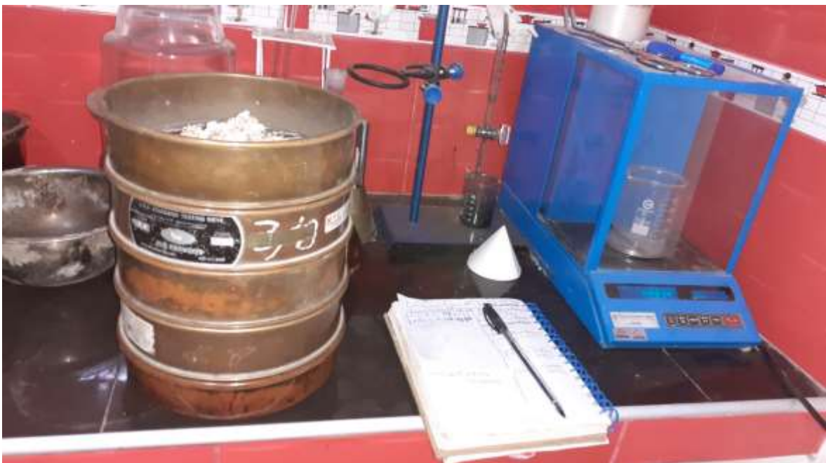
Figura: realizamos el ensayo granulométrico para la celulosa reciclada de papel bond
