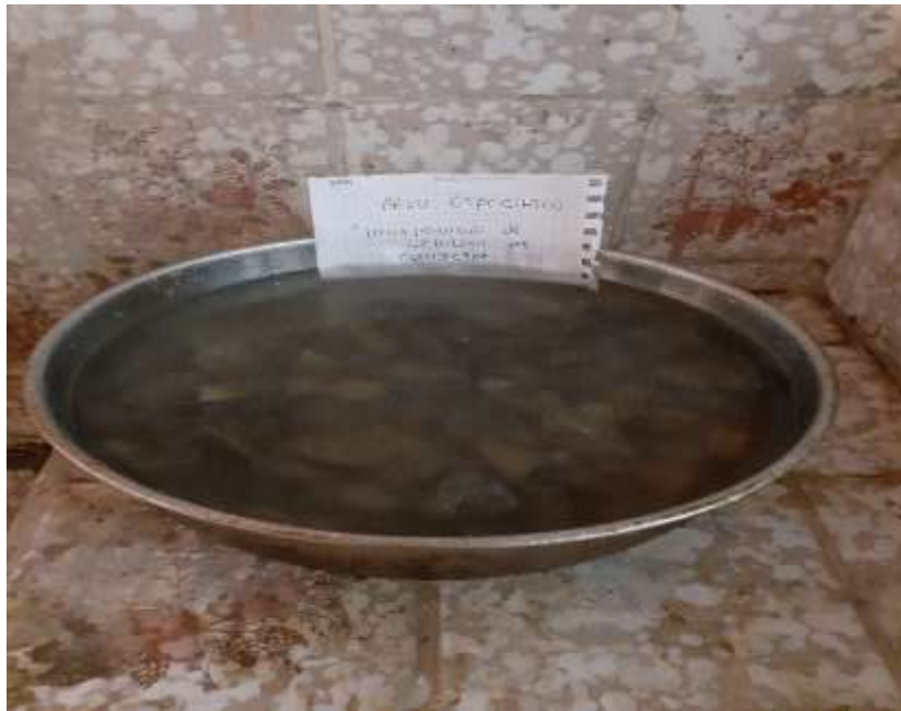
Figura: ensayo del peso específico y absorción del agregado grueso
