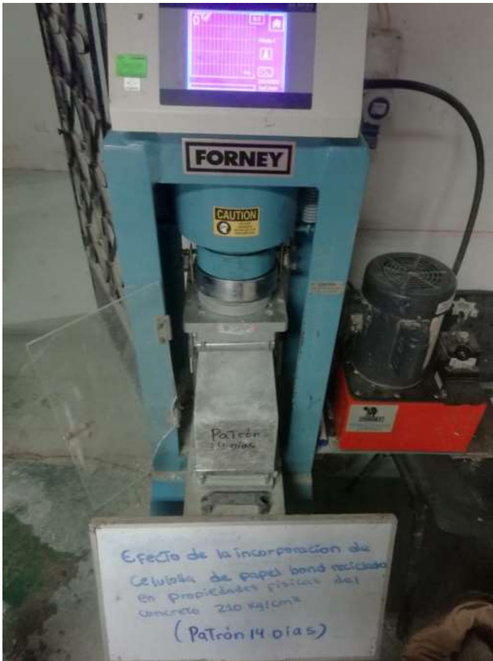
Figura: ensayo a flexión según norma ASTM C78
