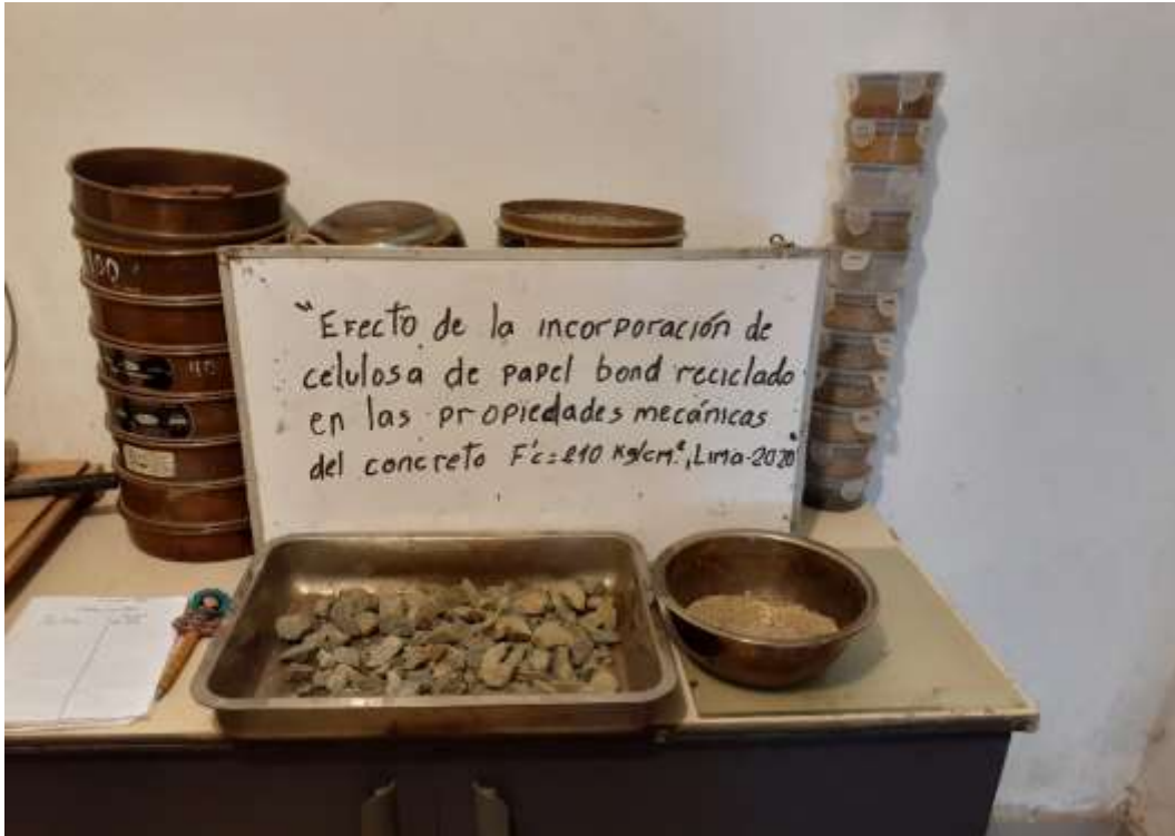
Figura: toma de muestra del agregado fino y grueso de acuerdo a la normatividad
