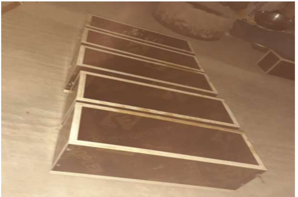
Figura: moldes para las vigas 15cm x 15cm x 50cm
