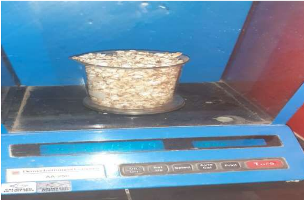
Figura: realizamos el pesado de la celulosa reciclada de papel bond
