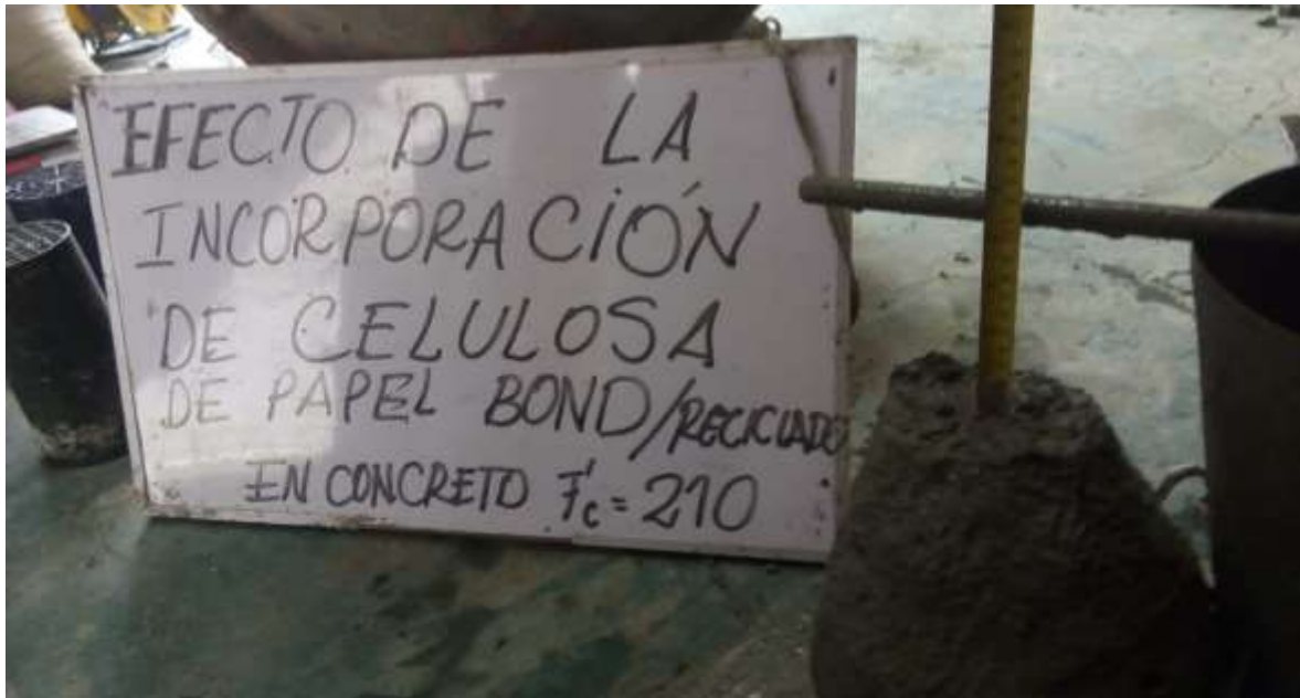
Figura: ensayo del SLUMP del concreto patrón
