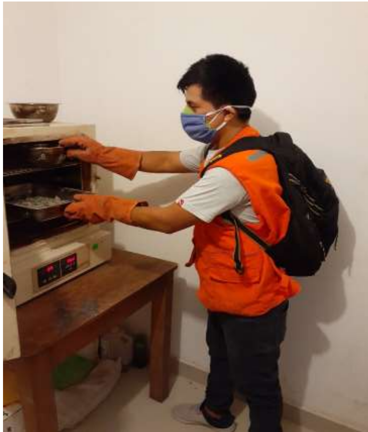
Figura: los agregados seleccionados estarán en el horno 5 horas
