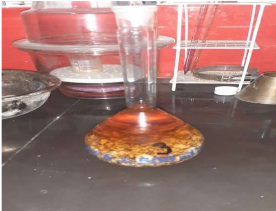
Figura: ensayo del peso específico y absorción de la celulosa de papel bond reciclado
