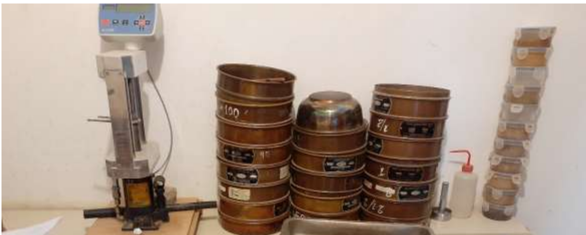
Figura: los tamices normados que se utilizaran en los ensayos granulométricos
