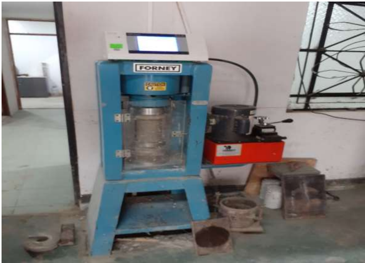
Figura: rotura de probetas según norma ASTM C36
