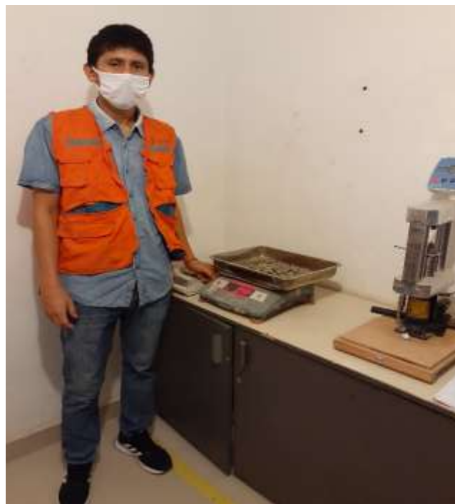
Figura: pesado del agregado grueso para la granulometría
