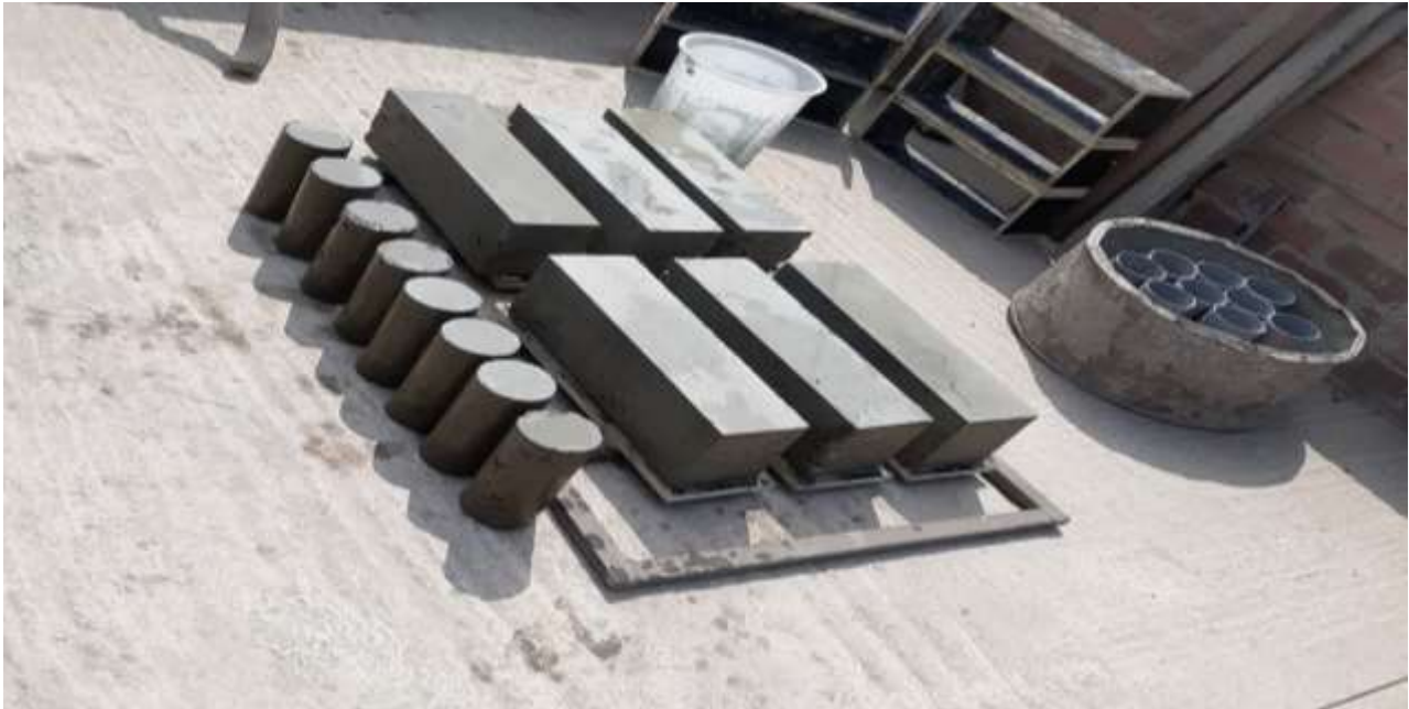
Figura: desencofrado de las probetas y las vigas
