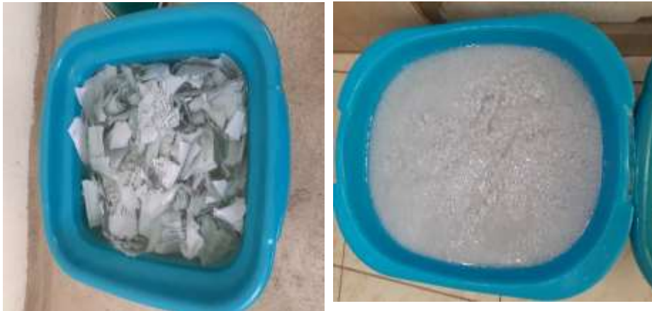
figura 8: extracción de celulosa de papel bond
