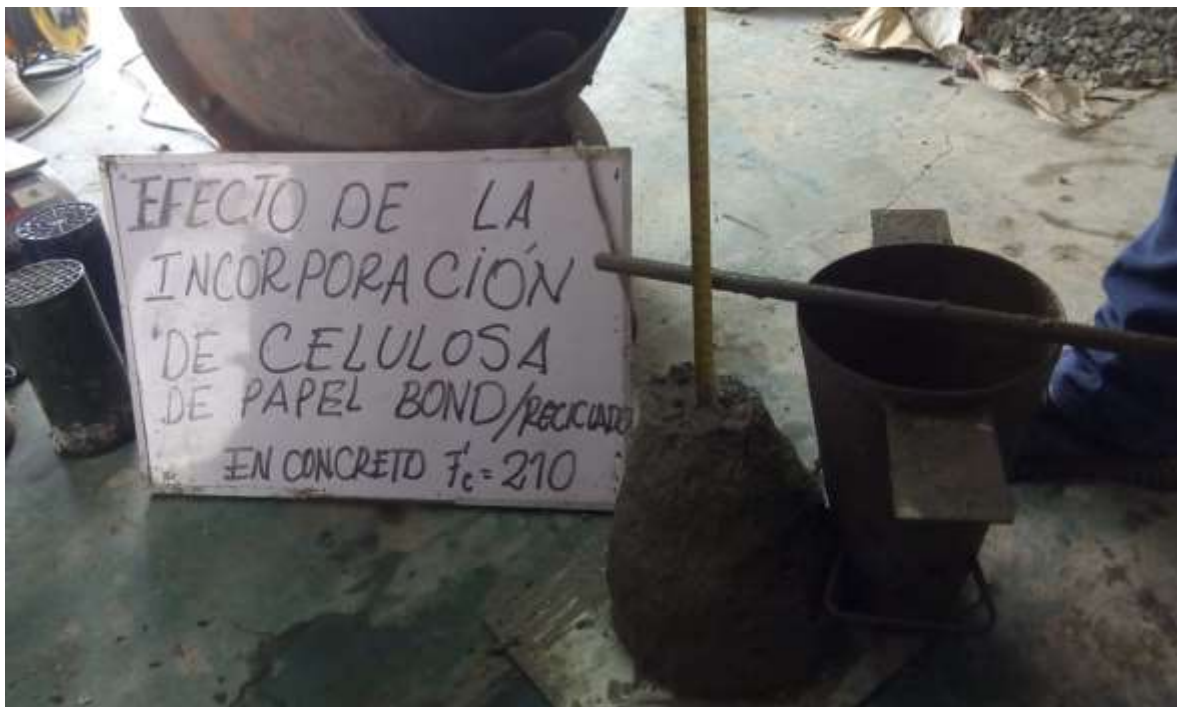
Figura: ensayo del SLUMP del concreto patrón con la adición de la celulosa reciclada de papel bond
