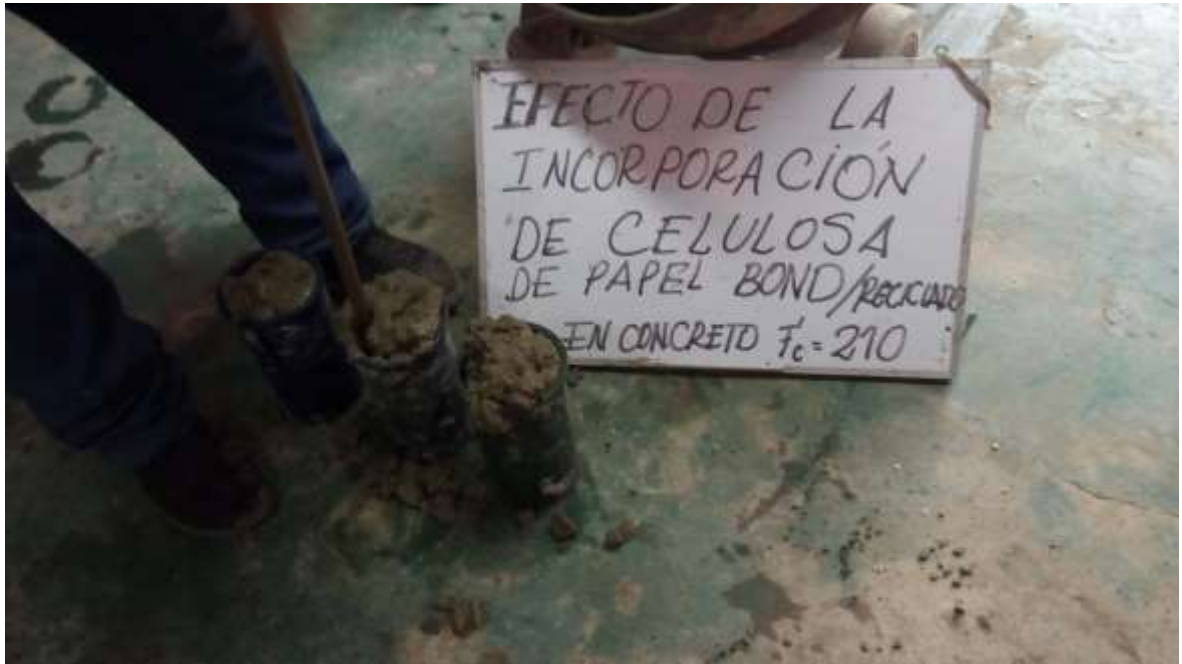
Figura: elaboración de las probetas según norma
