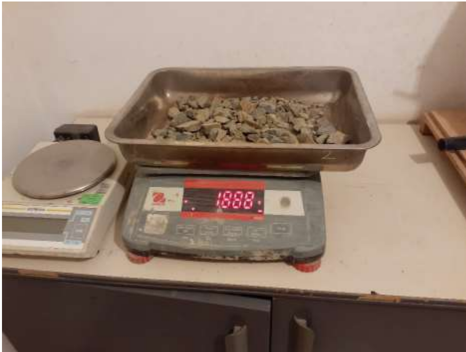
Figura: pesado del agregado grueso para el ensayo de granulometría
