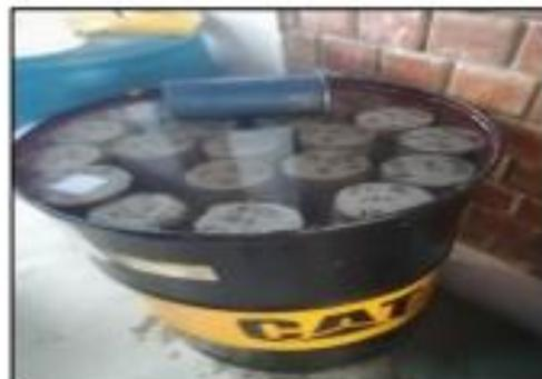
**Colocación de la probeta**
