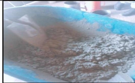
*Pesando y mezclando cada uno de los materiales del diseño para el concreto patrón.*
