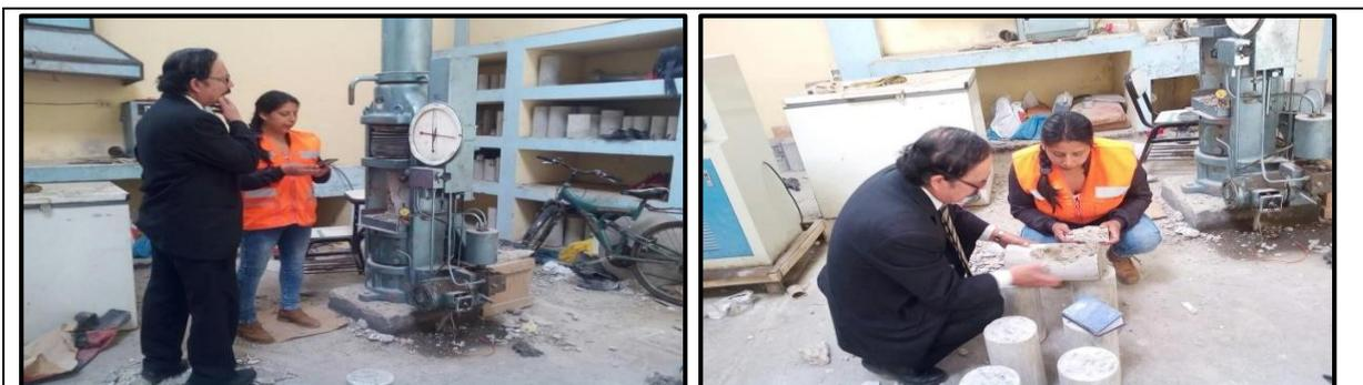
Con el apoyo de mi asesor de tesis M. en I. Héctor Albarino Pérez Loayza, se realizó la rotura del espécimen usando el deformímetro y se observó que el agregado grueso no ha sido afectado solo la pasta del concreto.
