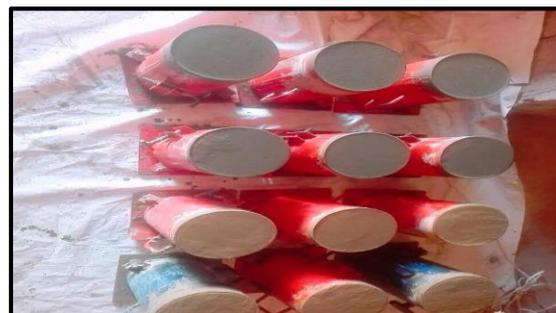
*Elaboración de los especímenes de concreto, para los ensayos de compresión.*
