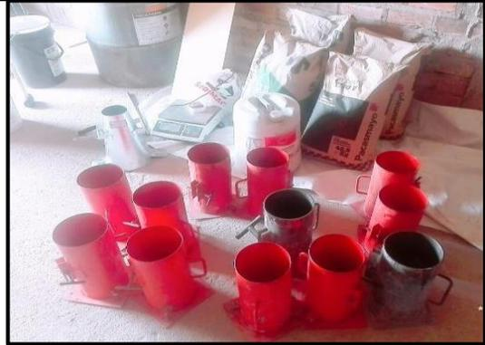
*Materiales utilizados para el diseño de mezclas: cemento, aditivo, moldes cono de Abrams, varilla y balanza, entre otros.*
