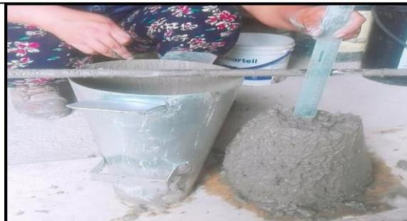
*Medición del Slump (asentamiento) mediante el cono de Abrams, del concreto fresco de cada tanda de mezclado.*
