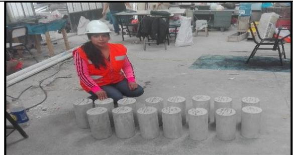
*Identificación, pesado, y medición de los especímenes para su posterior rotura.*
