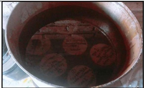
*Se muestra los especímenes de concreto con aditivo tanto en estado endurecido, y luego ser curados a los 7, 14 y 28 días.*
