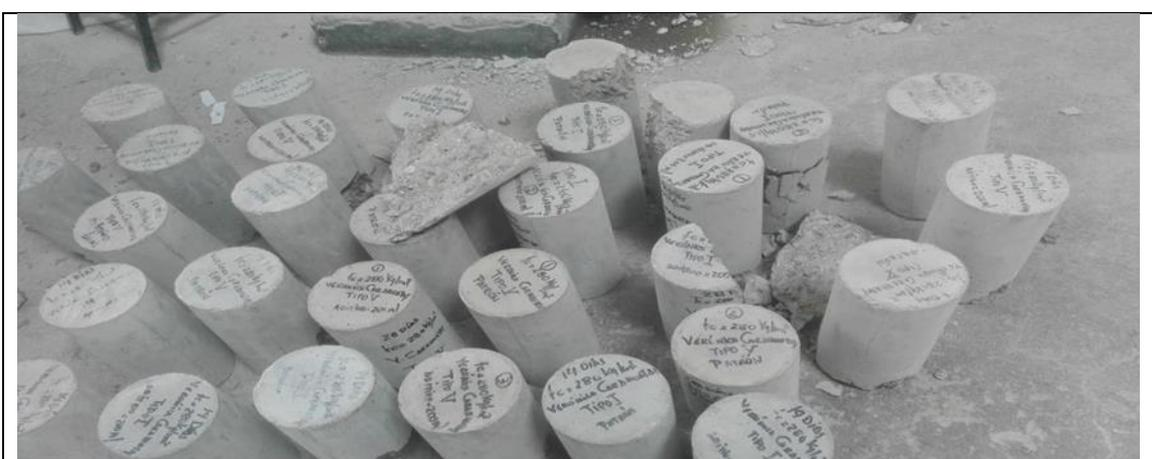
Fallas típicas obtenidas en los especímenes ensayados a compresión
