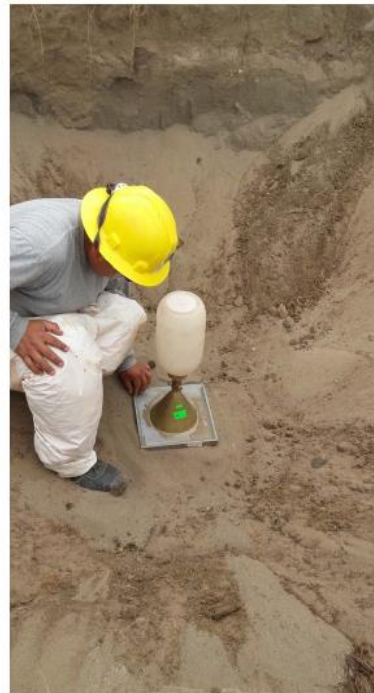
Foto N° 5: Calicata CA-CO16-103. Ensayo de densidad por el método del cono de arena.
