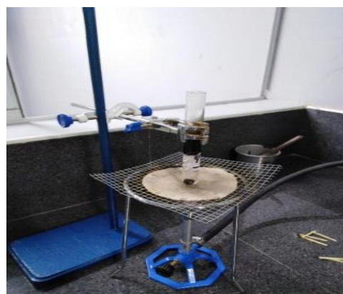
Figura 27: Desprendimiento del asfalto
