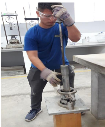
Figura 30: Compactacion de la briqueeta
