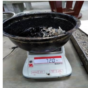
Figura 41: Peso de asfalto en relacion al peso de briqueta (6.00%)
