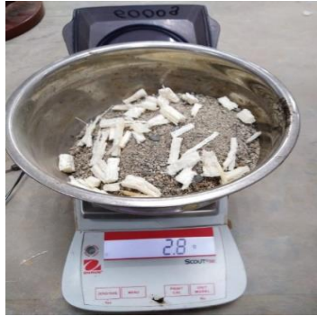
Figura 40 : Peso de bagazo de caña en relacion al peso de agregados ( 0.25%.)
