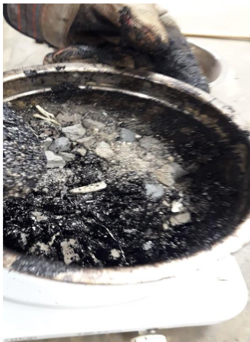
Mezclado de agregados y Asfalto a 140°C
