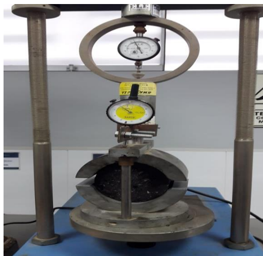
Rotura de Briqueta en Equipo Marshall y Recopilación de datos
