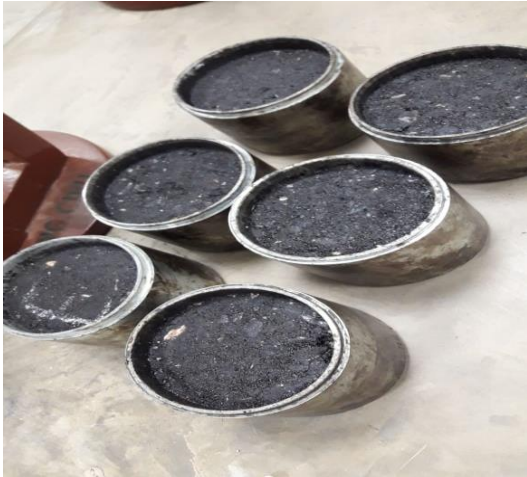
Enfriado de Briqueta por 24h
