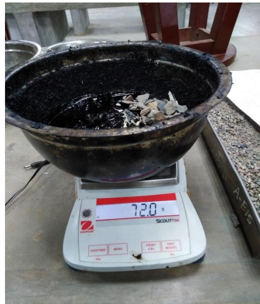
Pesado de Agregados y Asfalto a 140°C
