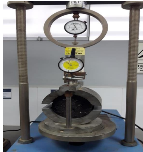
Figura 33: Rotura de la briqueta
