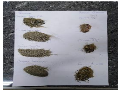
Figura 24: Desgaste del agregado
