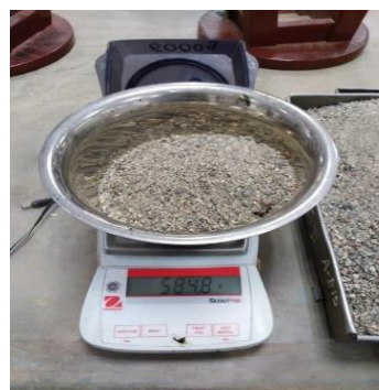
Figura 39: Peso de arena en relación al peso de briqueta (48.72%)
