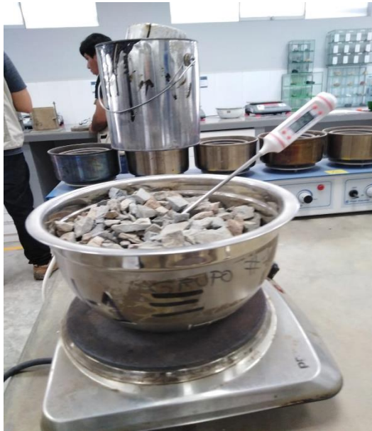
Calentado de agregados y Asfalto a 140°C
