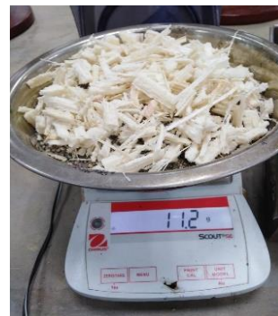
Figura 44: Peso de bagazo de caña en relacion al peso de agregados (1.00% )
