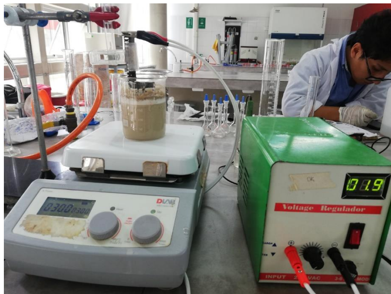
OXIDACION DEL EFLUENTE, ETAPA PELAMBRE
