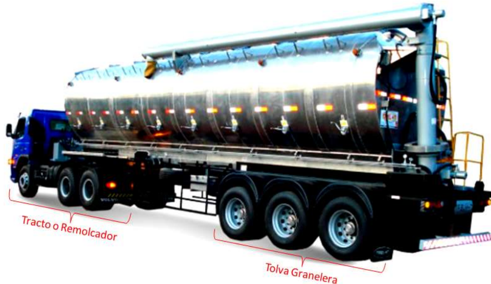
Figura 6. Modelo de Tolva Granelera (Bombona); Tolva utilizada para el transporte de alimento balanceado de las plantas de alimento balanceado a las granjas, tomado de TRIEL HT Logística Agroindustrial, http://pt.trielht.com.br/logistica-agroindustrial/produtos/novos/181/modelo_mega_aluminio , Copyrigh 2019.
