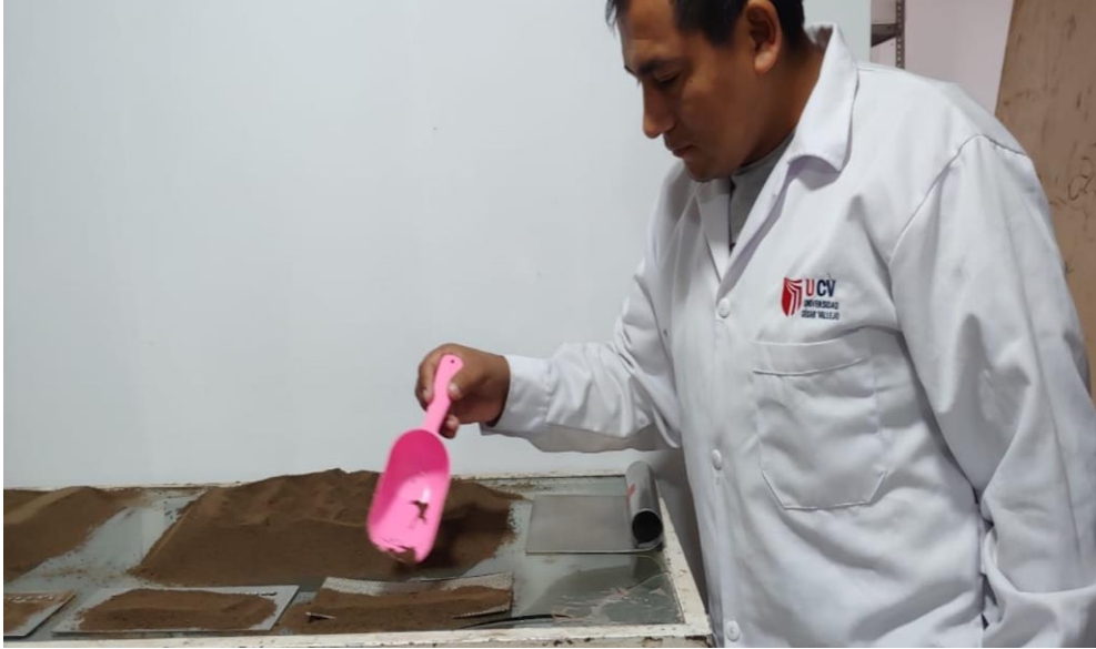
Figura 15: Realización de la técnica de CUARTEO al suelo contaminado. Fuente: Elaboración propia, 2019
