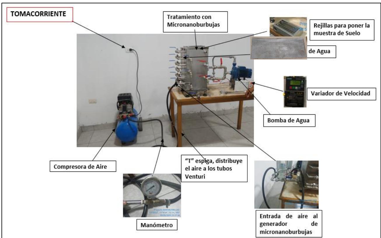
Figura 7: Descripción del equipo generador de Micro-nanoburbujas
