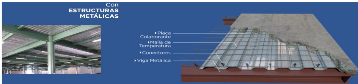
Figura 123. Elementos de la estructura
