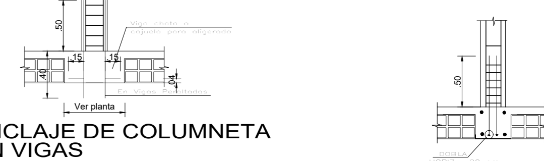
ANCLAJE DE COLUMNETA EN DOBLE VIGUETA V.R
