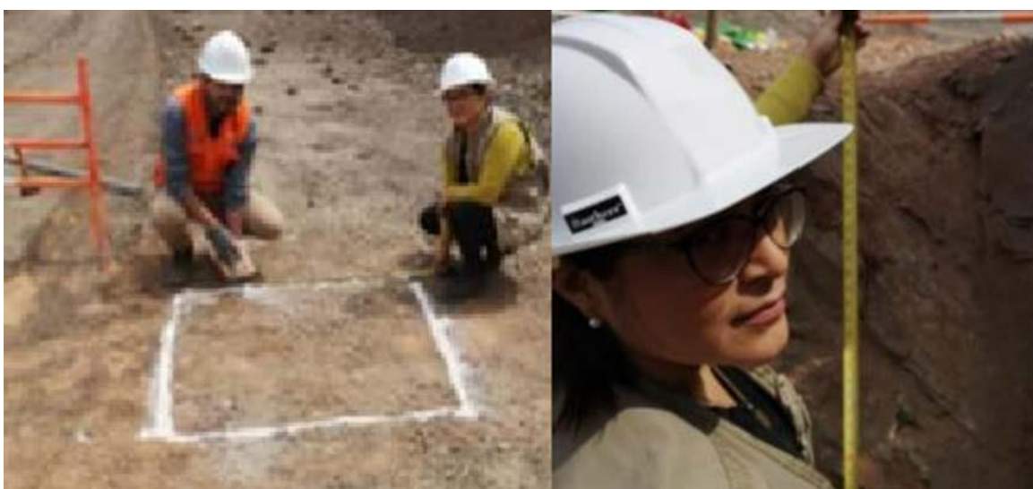
Figura 6. Excavación de la calicata.
