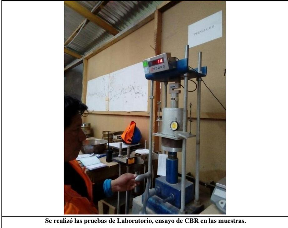
Se realizó las pruebas de Laboratorio, ensayo de CBR en las muestras.
