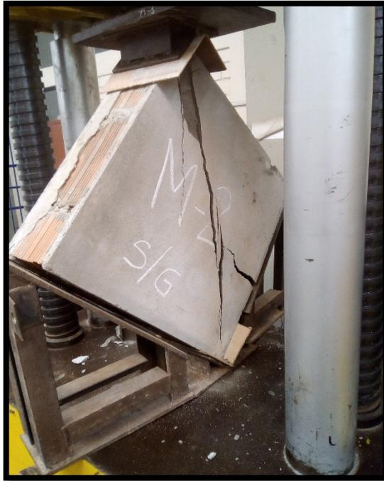
**Figura 26.** *Falla por tracción diagonal murete 2*
