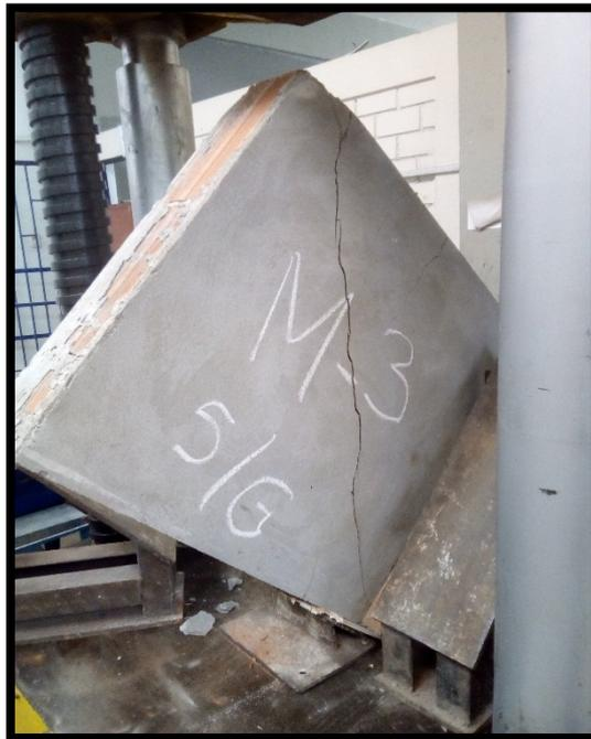
**Figura 27.** *Falla por tracción diagonal murete 3*
