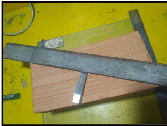
**Figura 14.** *Ensayo de alabeo*
