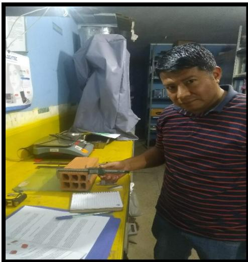
**Figura 12.** *Ensayo Variación Dimensional*
